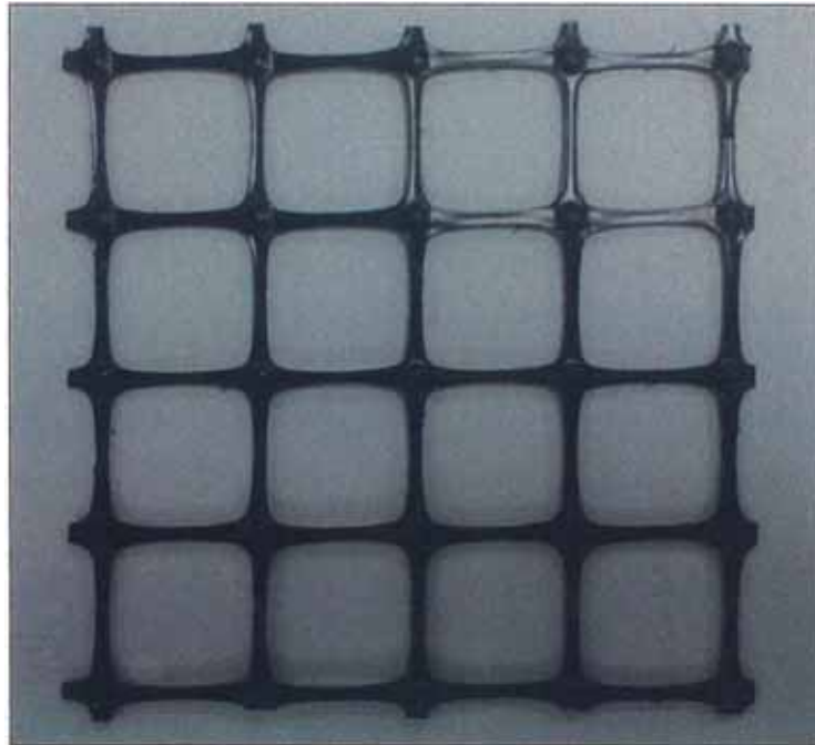
Figura N°2.17 Geomalla extruida del tipo biaxial. Fuente, Cortesía de Andex del Norte.
