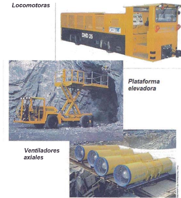
Figura 15: Equipos auxiliares (ventilación, grupos electrógenos, etc)
