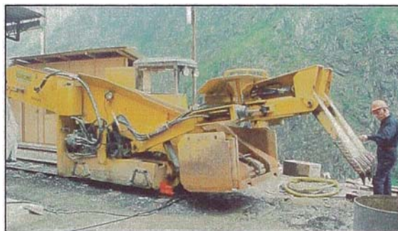
Figura 9: Pala eléctrica sobre rieles para carga continua
