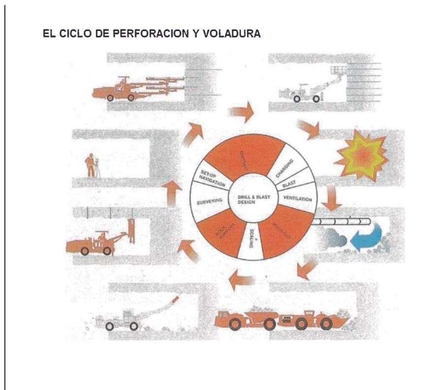
Figura 23: Esquema del ciclo de Perforación y Voladura
