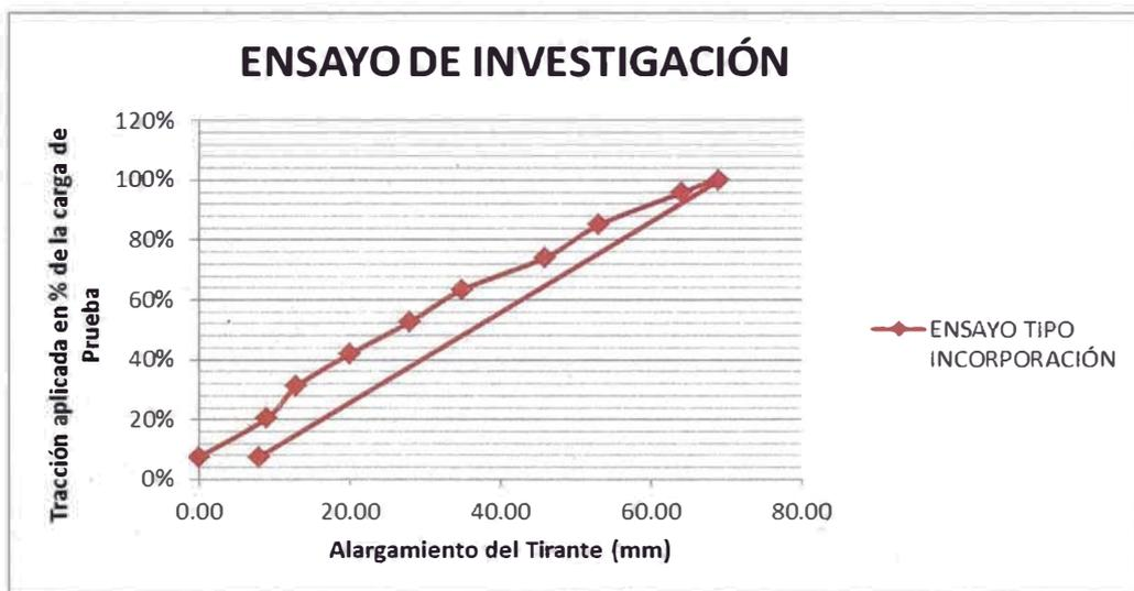
Figura N°28: Grafica de los ciclos incrementales de carga con el desplazamiento para un bulbo de anclaje igual a 6 metros
