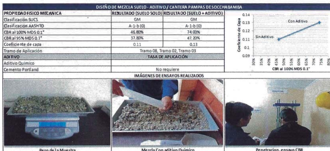
Figura N°5.4: Resultados del aditivo en el tramo 08, tramo 02 y tramo 03
