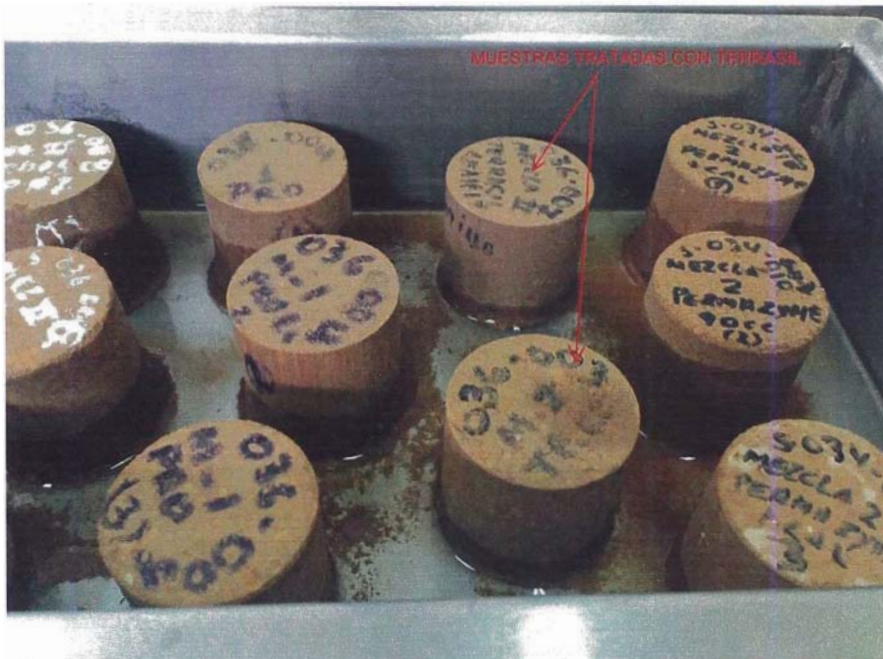
Figura N°5.14: Probetas tratadas sometidas a un recipiente con agua
