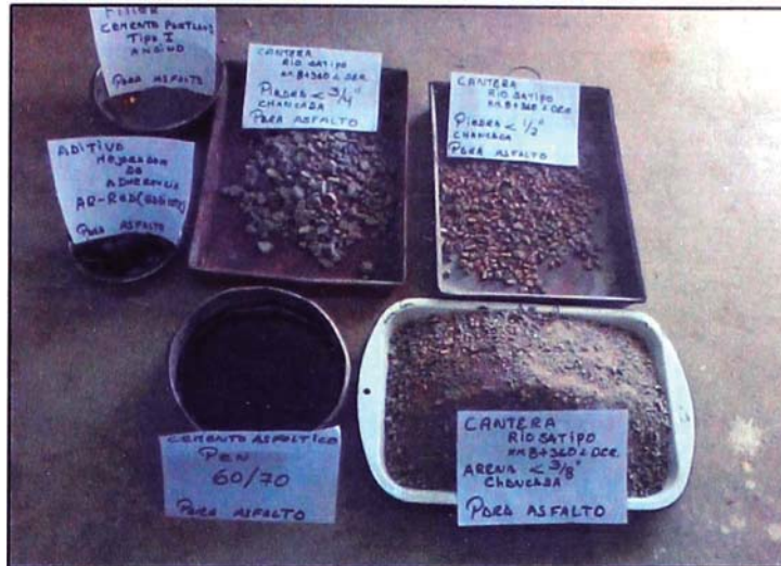
Figura N°4.1: Materiales para la preparación de la mezcla asfáltica con aditivo, agregado fino, agregado grueso, filler, cemento asfáltico y aditivo mejorador de adherencia.
