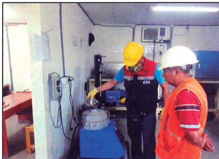
Figura N°5.2: Lavado Asfáltico en la centrifuga.
