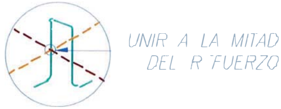
Figura 13: Forma de unir silletas con arriostres centrales. Fuente: Planos de despiece de AASA.
