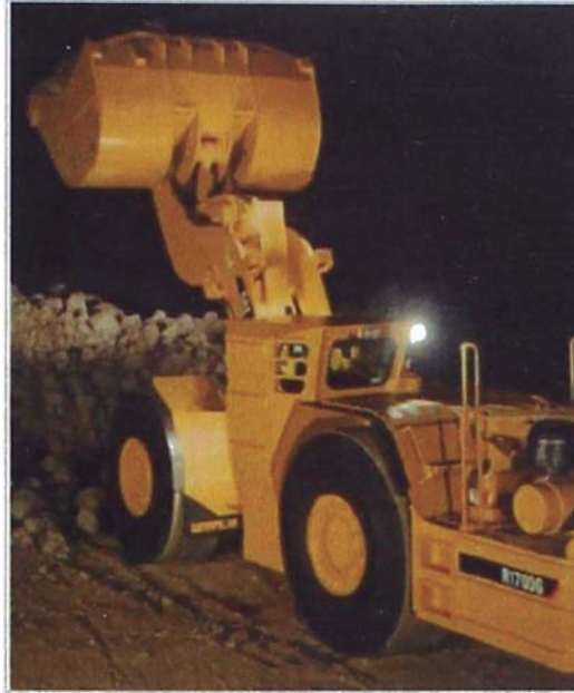
Figura N° 04.- Vista lateral del scoop de 6.0 yd 3
