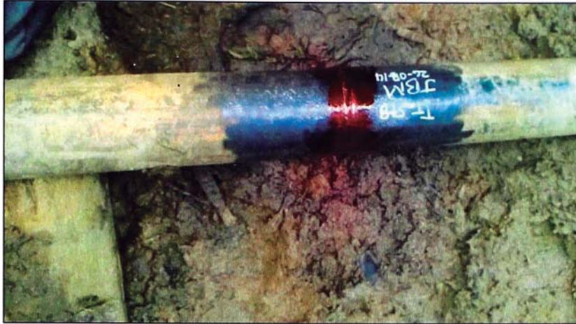
Figura N°27: Ensayo de Líquidos Penetrantes en línea de 6" - Dorissa (Fuente: Pluspetrol)
