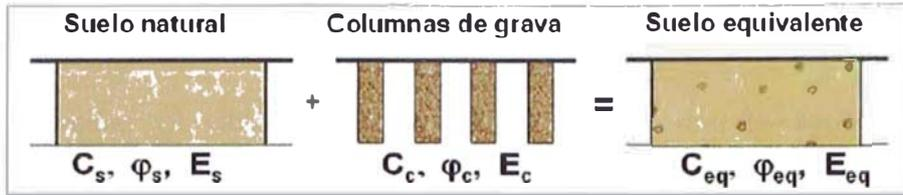
Figura 2.2.- Esquema del suelo equivalente.
