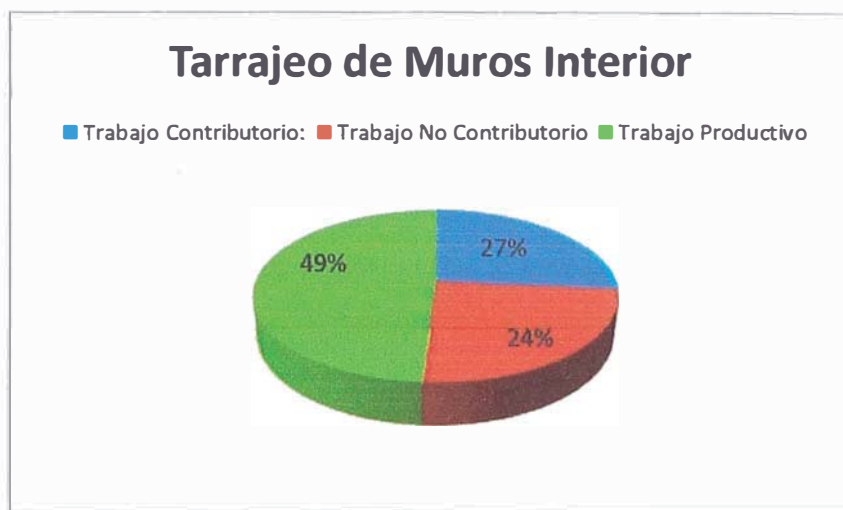
Cuadro 3.14: Ocupación del tiempo – Tarrajeo de muro interior
