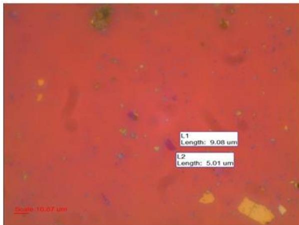
**Figura N° 4.10:** Micrografía de GQM soportados en un sustrato de Si/SiO<sub>2</sub> con un espesor de SiO<sub>2</sub> de 300 nm.
