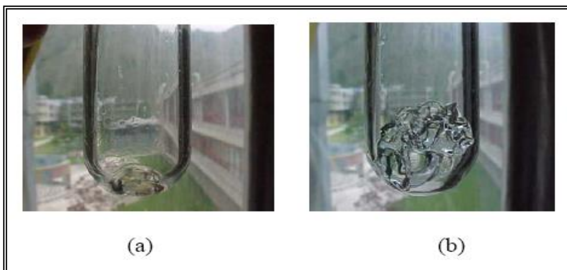
Figura N° 7: Fotografías de (a) hidrogel no hinchado basado en un complejo polielectrolito de quitosano y ácido itacónico y (b) el mismo hidrogel de (a) hinchado en medio ácido. (Tomado de [2])
