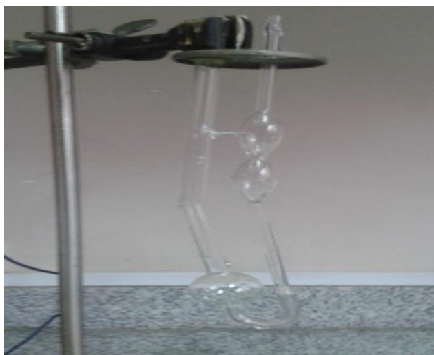
Figura N°24. Imagen de Viscosímetro de Ostwald utilizado para cálculo de los tiempos de caída de las distintas soluciones de quitosano.
