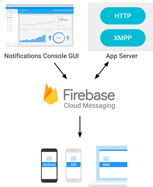
FIGURA 4.2: Esquema de funcionamiento FCM. Fuente: Página de inicio Firebase. [30]
