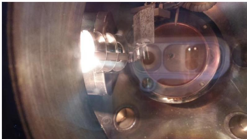
Figura 2.10. Limpieza de la muestra antes de realizar la espectroscopia de electrones Auger.
