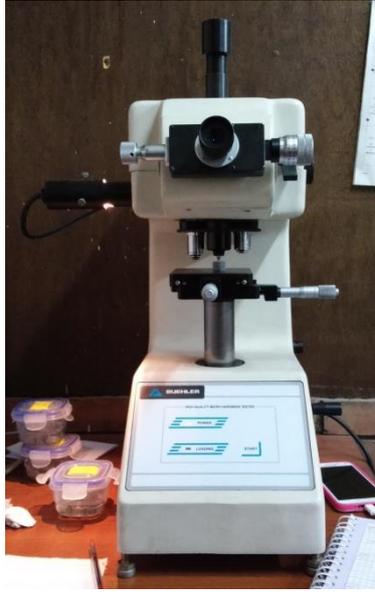
*Figura 2.12.* Equipo comercial BUEHLER para obtener la dureza de la muestra.
