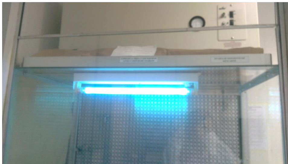
Figura 26. Cabina de flujo laminar clase I.
