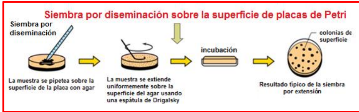
Figura 40. Siembra por diseminación de la dilución bacteriana sobre la superficie de la placa con agar.
