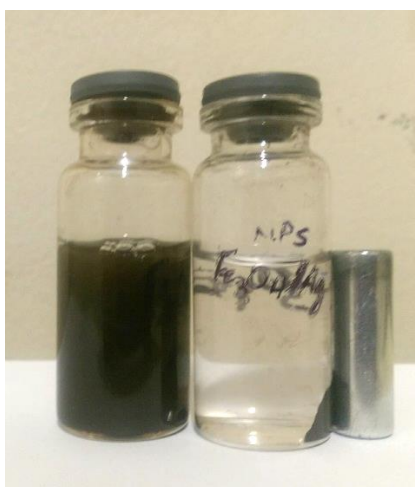
Figura 38. Proceso de separación del nanocompuesto en dispersión con un imán de neodimio para obtener la muestra sólida.
