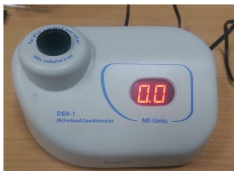
Figura 24. Densitómetro, para medir la densidad óptica de la suspensión bacteriana.
