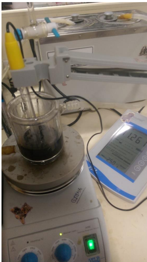
Figura 35. Dispersión final del nanocompuesto de \text{Fe}_3\text{O}_4/\text{Ag} , con un pH final de 11.26.
