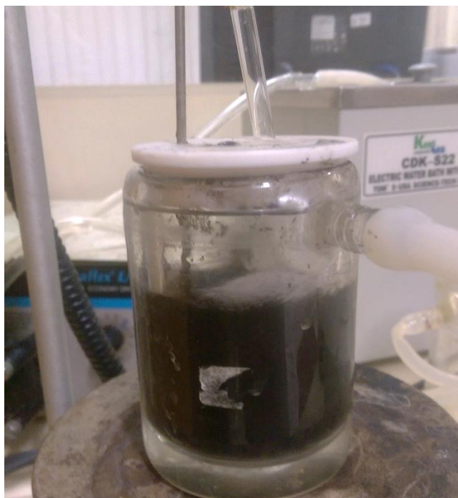
Figura 31. Dispersión de magnetita en el proceso de envejecimiento con burbujeo de N 2 .
