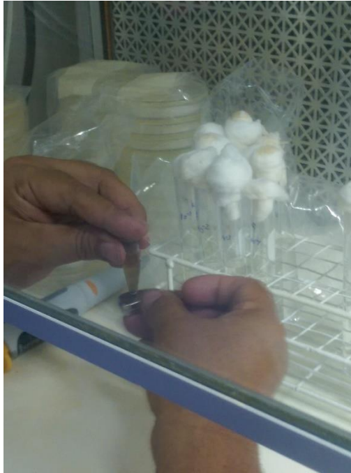
Figura 44. Separación del sobrenadante con un imán de neodimio.
