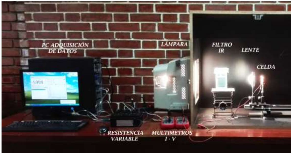
Figura 25. Sistema construido para determinar la eficiencia de una celda solar.
