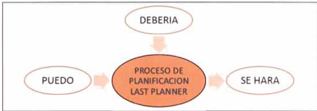
FIGURA 3.1 Funcionamiento básico del Last Planner System
