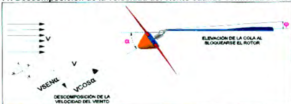
Figura 2.11: Descomposición de la velocidad del viento cuando comienza el bloqueo
