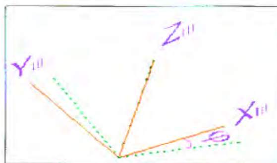
Figura 2.10: Orientación del sistema de coordenadas de la base II a la base III
