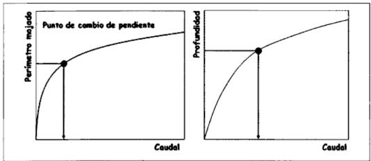
Figura 2.3 Métodos hidráulicos
