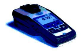
Figura 2.16 Medidor de turbiedad
