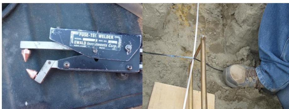
**Figura N° 53: Pinzas de Soldadura con Puntas de Cobre**
