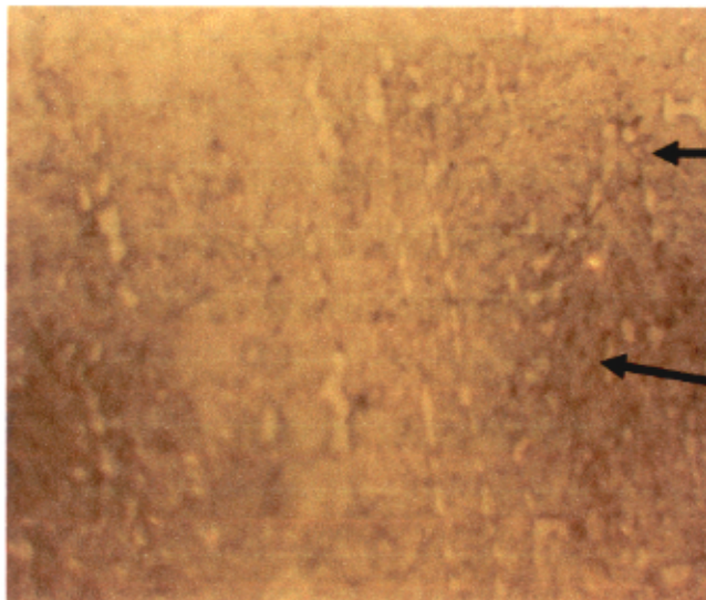
MICROFOTOGRAFÍA N° 19 200X (REACTIVO DE VILELA) MARTENSITA Y CARBURO DE TUNGSTENO (CAPA 3)
