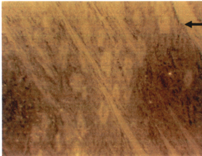
MICROFOTOGRAFÍA N° 13 500X (REACTIVO DE VILELA) CARBURO DE CROMO (CAPA 2)
