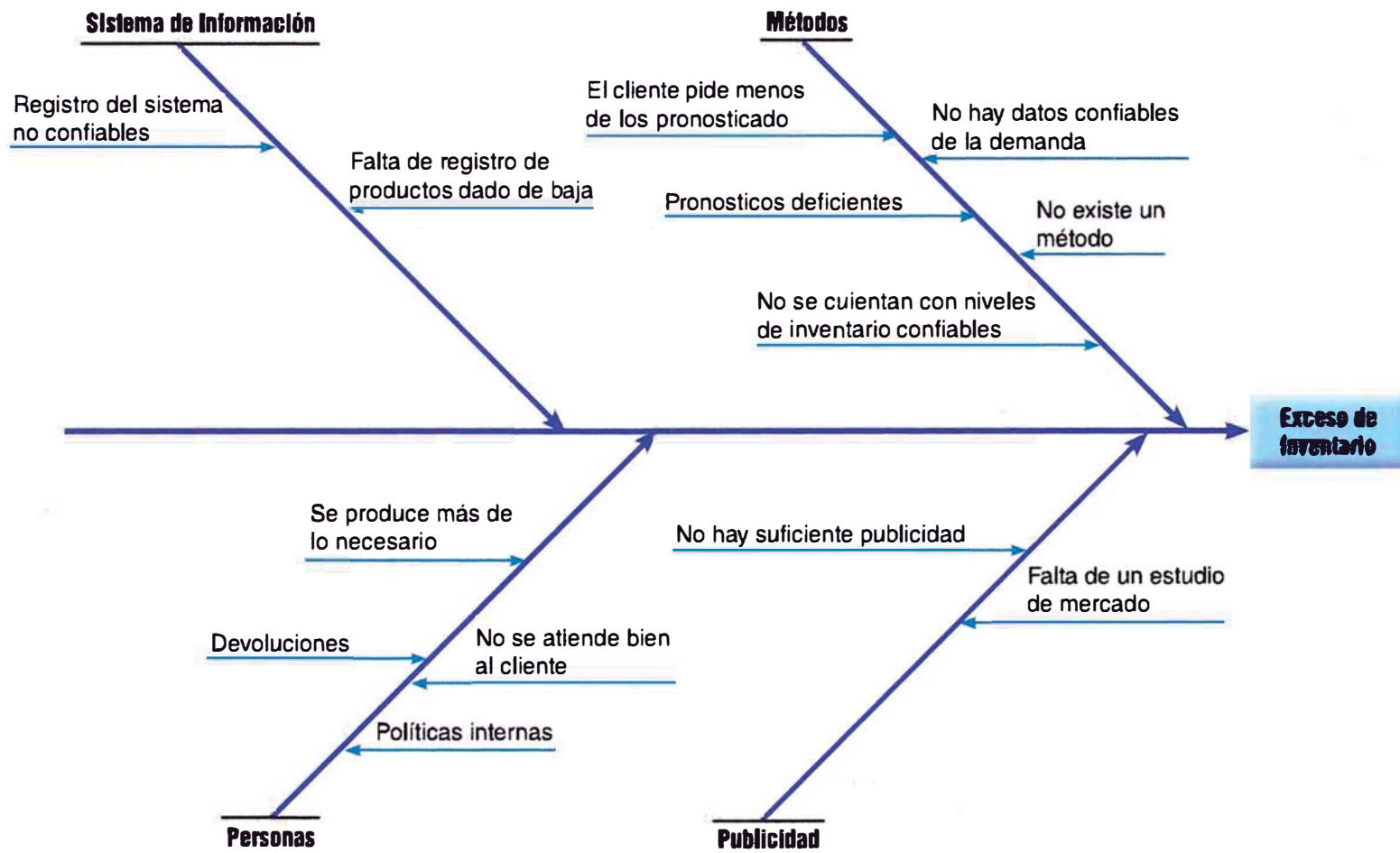
FIGURA 3.1 Diagrama Causa-Efecto para el problema planteado "Exceso de inventario".
