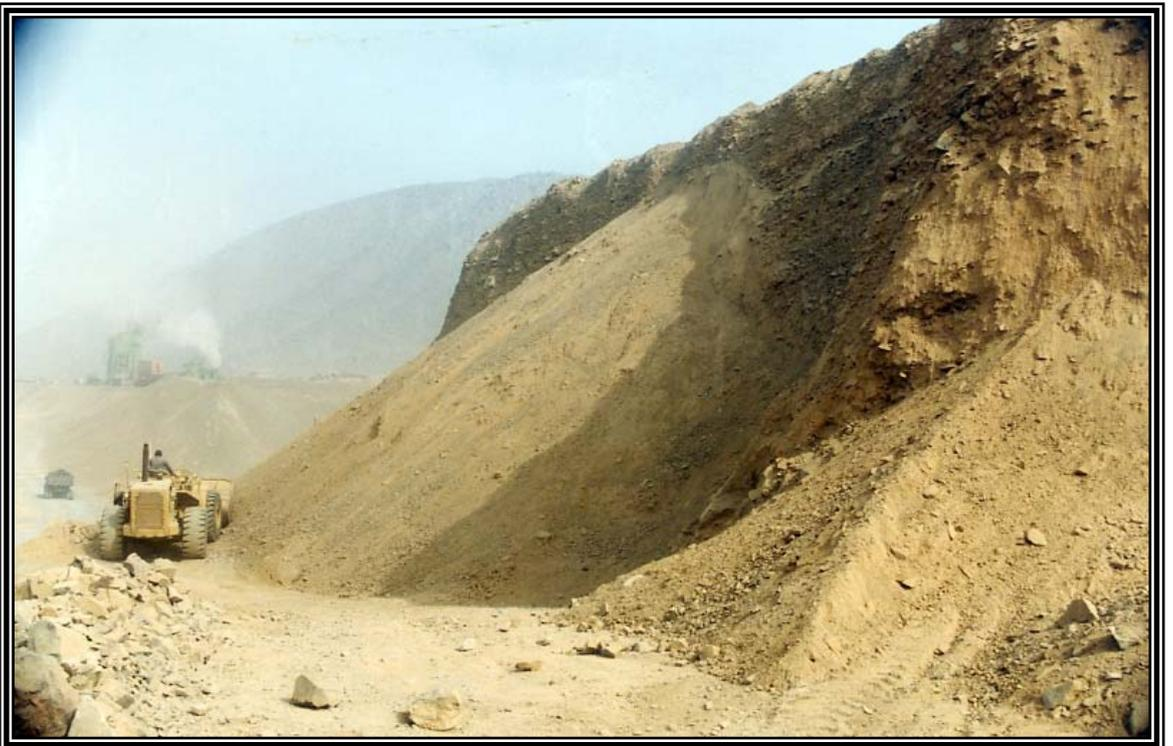
**Foto N° 4.-** Explotación en la concesión minera “Ernesto J.D.L.” el cargador frontal no tiene la cabina de seguridad del operador y hacia el fondo se aprecia otras actividades mineras generando contaminación del medio ambiente, por la generación de polvo.
