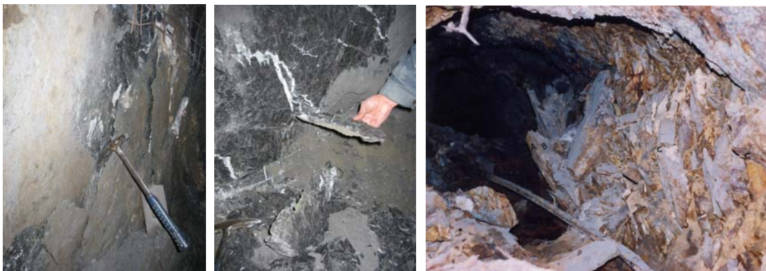
Figura 1.7: Fallas inestables de la roca (Liberación de energía potencial – Estallidos de rocas)
