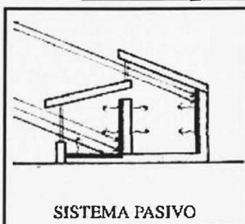
El principio del uso pasivo de la energía solar es la transformación de potenciales energéticos existentes procedentes de fuentes naturales de energía, para el calentamiento de edificios, renunciando casi por completo a la tecnología, es decir con medidas puramente proyectuales.
