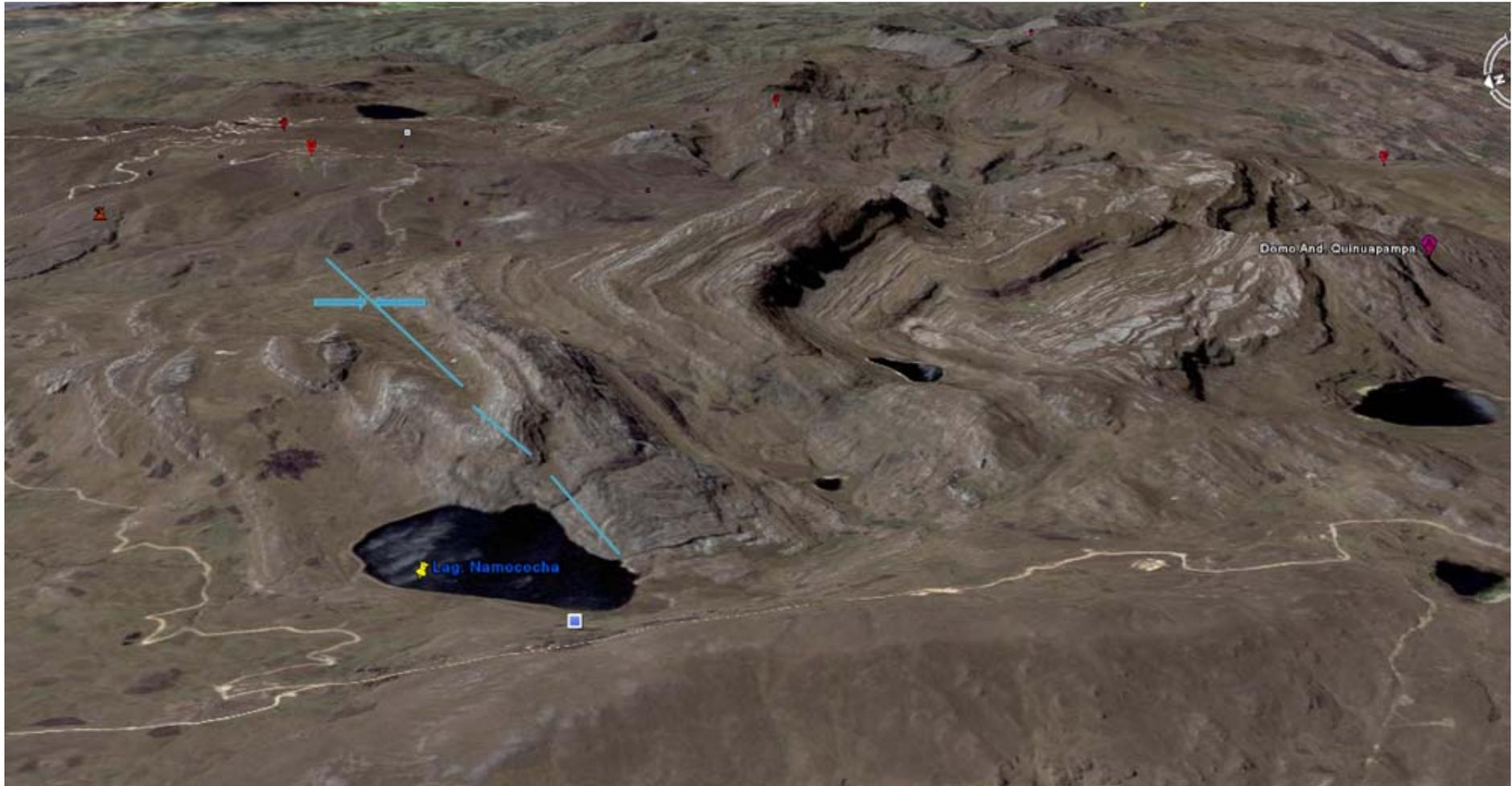
**Fig. 2.29** Foto Satelital, Mirando al este. Muestra el plegamiento intenso tipo Sinclinatorio, dentro de la unidad de deformación anular. Los ejes del plegamiento tienen rumbo NS y se encuentran buzando al Sur, arriba de la laguna Nanococho.
