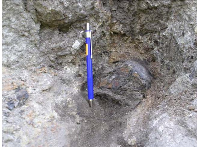
**Fig. 3.4** 787370E, 9239765N, Foto en talud de acceso en Quengorrio, mostrando fragmento de tronco de árbol carbonizado en flujo piroclástico de cristales y líticos, de composición dacítico.
