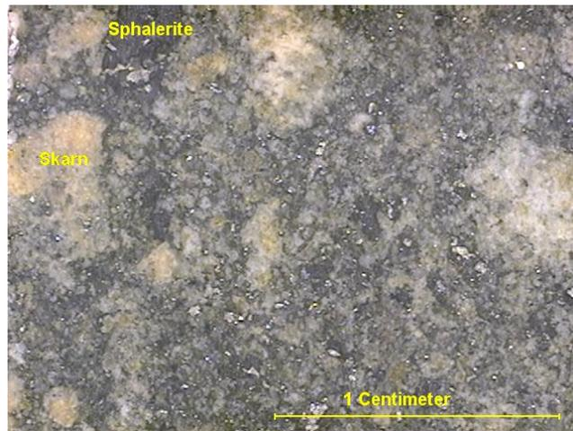
**Fig. 2.2** MPE-90, 275m: La foto en sección delgada muestra una brecha compuesta de fragmentos líticos de skarn y abundante sulfuros.
