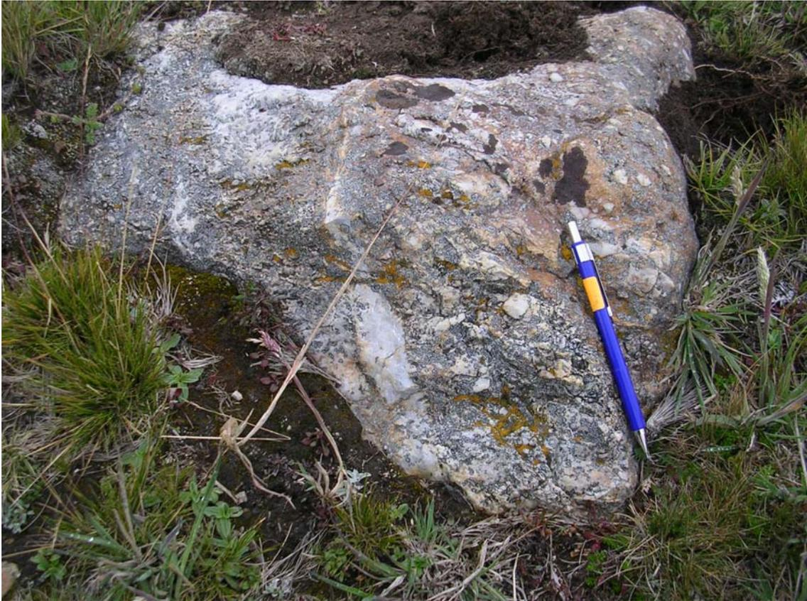
**Fig. 3.15** Brecha hidrotermal sobreimpuesta a brecha tectónica, debido a la intensa molienda de la matriz asociada con óxidos, sobre secuencia calcárea silicificada.
