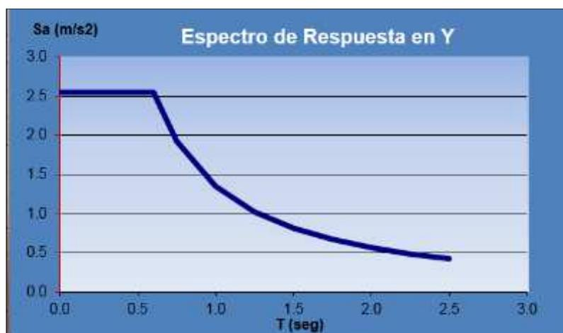
Figura 2.11.- Espectro de respuesta para el eje Y
