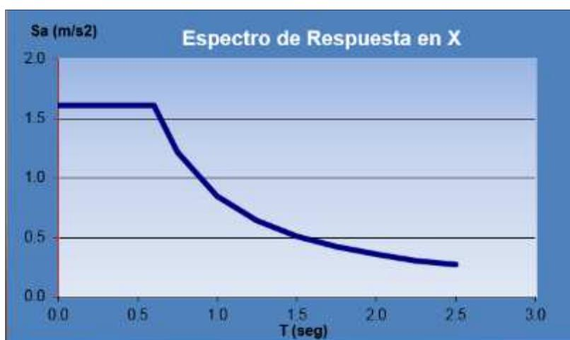
Figura 2.10.- Espectro de respuesta para el eje X
