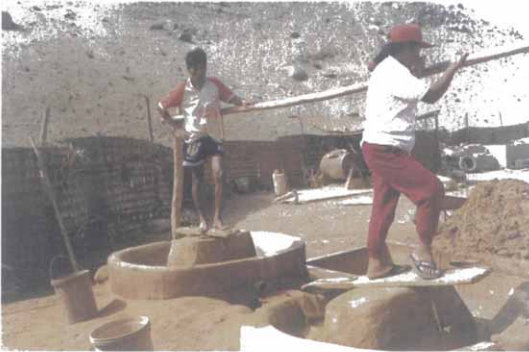
FOTO N° 10 : Imagen de una planta artesanal para la recuperación de oro, Chala.
