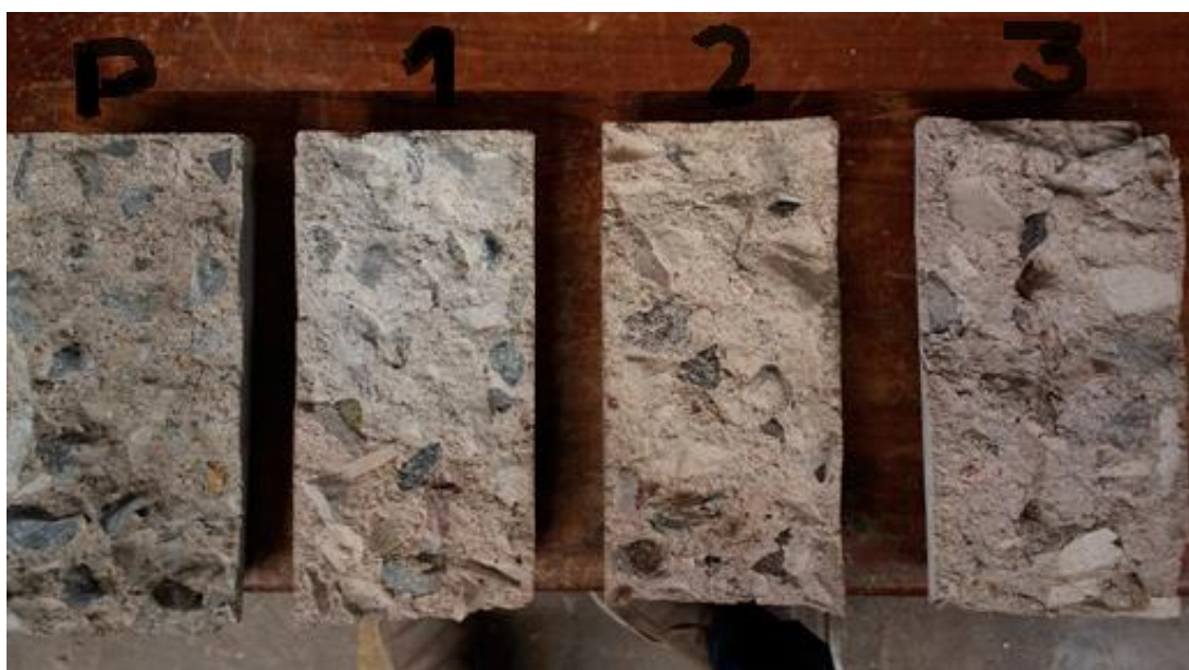
FOTO E.6 Grado de fisuración, textura y coloración en muestras Patrón (P), a 1 hora, 2 horas y 3 horas de exposición al fuego directo, en probetas de 4"x8" para el concreto de a/c=0.70 .
