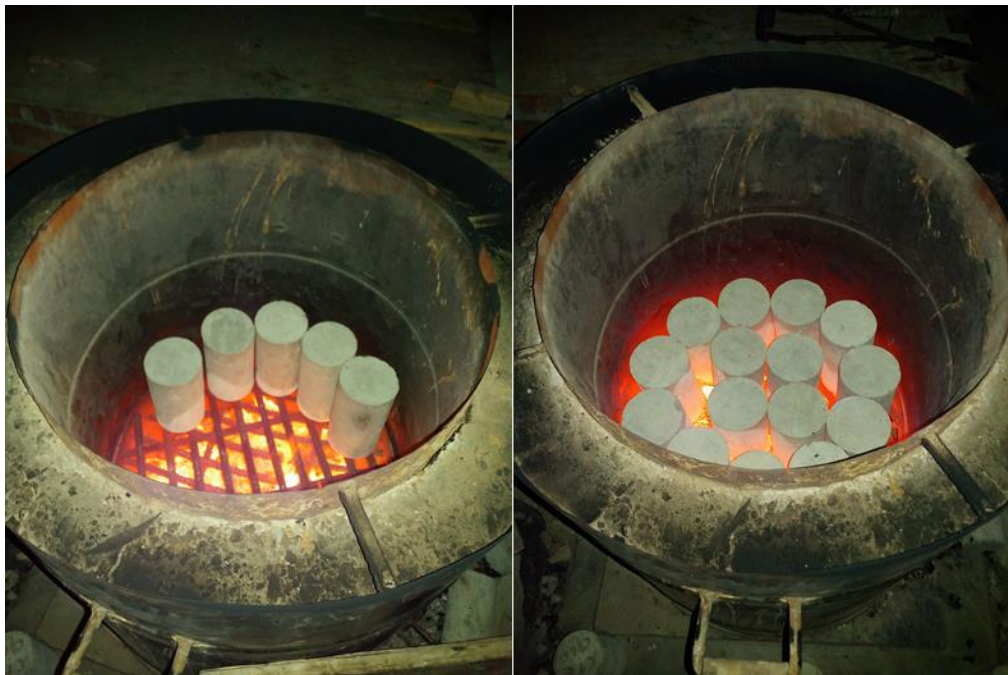
FOTO E.1 Quemado de muestras de 4"x8" para el ensayo de compresión para el concreto de a/c=0.60 .
