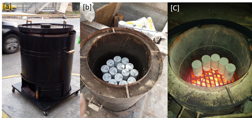
FIGURA 3.11 Horno utilizado (a) Horno acabado final, (b) estructura del horno, (c) parrilla de soporte de muestras.
