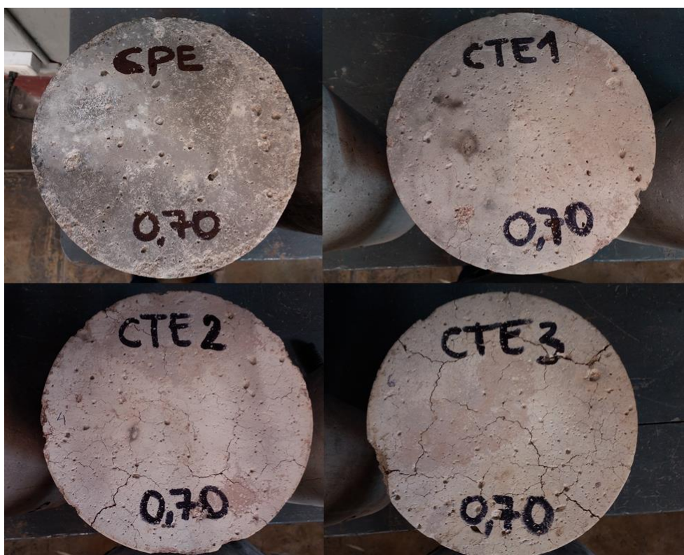
FOTO E.4 Agrietamiento en muestras Patrón (P), a 1 hora, 2 horas y 3 horas de exposición al fuego directo, en probetas de 6"x12" para el concreto de a/c=0.70 .
