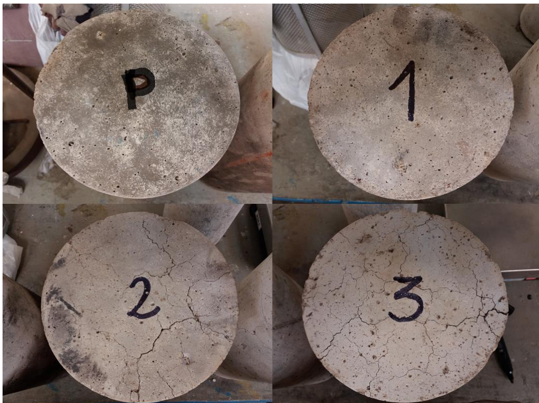
FOTO E.2 Grado de fisuración en muestras Patrón (P), a 1, 2 y 3 horas de exposición al fuego directo, en probetas de 6"x12" para el concreto de a/c=0.65 .
