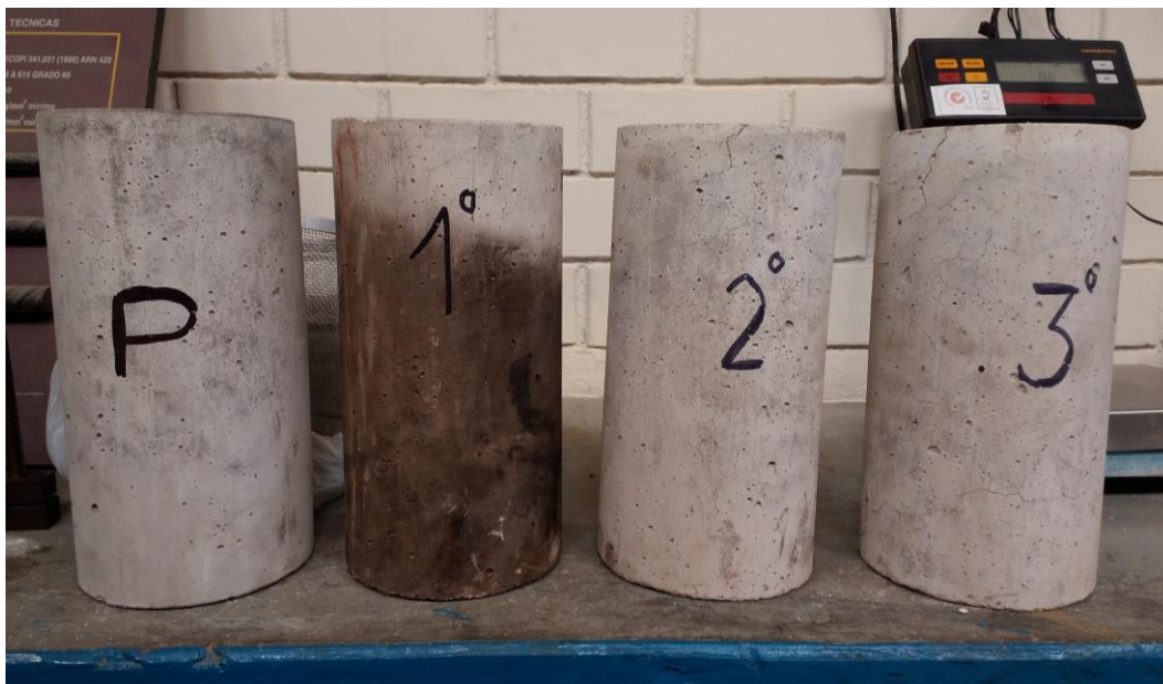
FOTO E.3 Muestras Patrón (P), a 1 hora, 2 horas y 3 horas de exposición al fuego directo, en probetas de 6"x12" para el concreto de a/c=0.65 .
