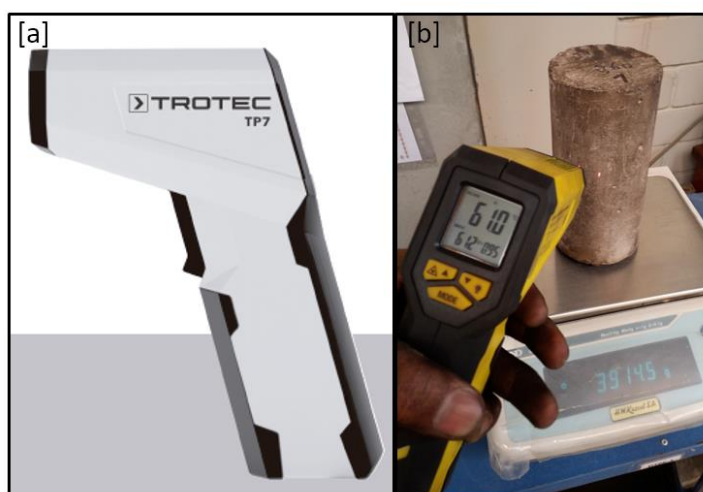
FIGURA 3.12 Termómetro IR digital (a) pirómetro TP7, (b) lectura de temperatura de muestra cilíndrica.
