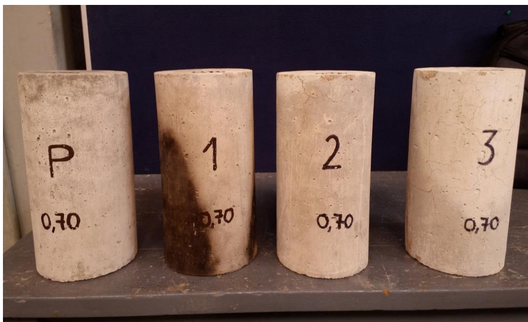
FOTO E.5 Muestras Patrón (P), a 1 hora, 2 horas y 3 horas de exposición al fuego directo, en probetas de 6"x12" para el concreto de a/c=0.70 .
