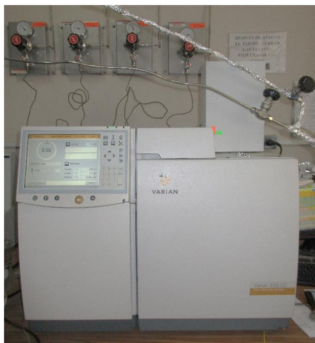
Figura 2.3. Cromatógrafo de gases GC-VARIAN-450. Ubicado en el Laboratorio de Investigación de Físicoquímica de la Facultad de Ciencias-UNI.
