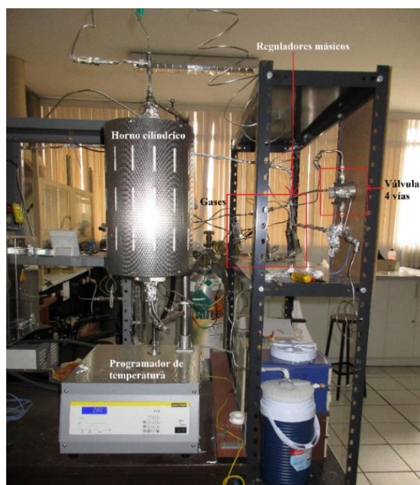
Figura 2.2. Sistema de reacción para la deshidrogenación oxidativa del etano con los equipos en el laboratorio de Fisicoquímica-Facultad de Ciencias-UNI.
