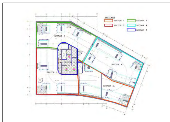
Figura N° 46: Sectores de Muros Anclados y techos en sótanos.
