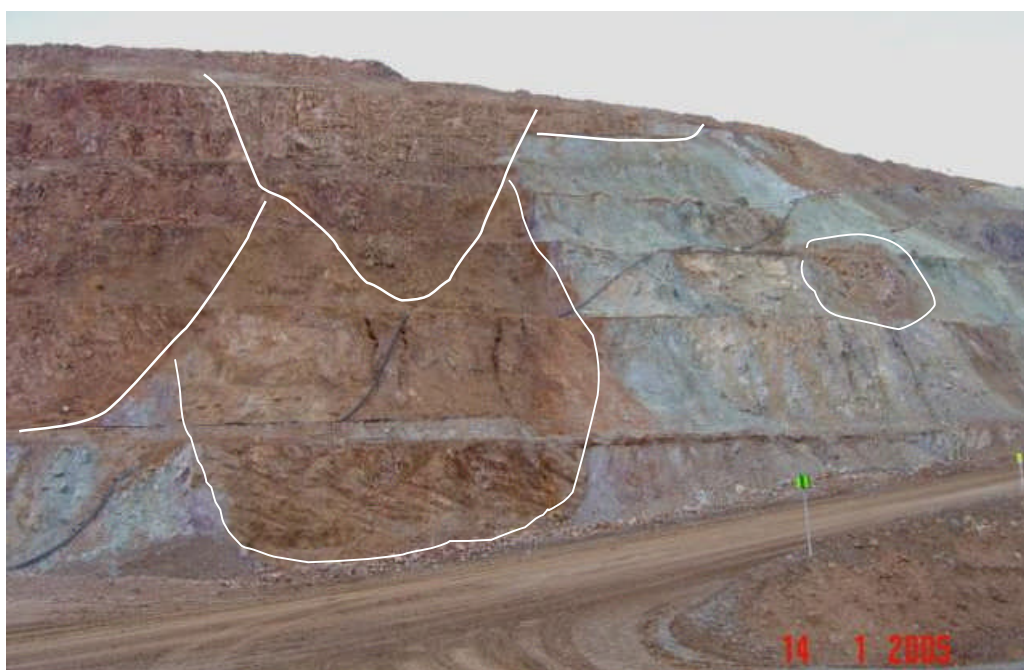
Foto N° 22: Nivel 3825, sección D-D'. Pared W del tajo. Se observa megabloques deslizados sucesivos e imbricados, bloques de mineral bordeado soportados por material argílico.
