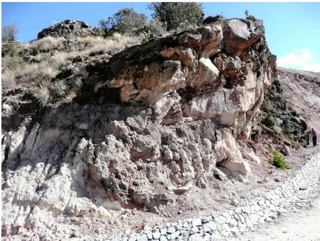
Foto N° 34: Sector norte del tajo (debajo del In pit N); megabloque de cuarzo-alunita deslizado sobre material coluvial y guijarros.
