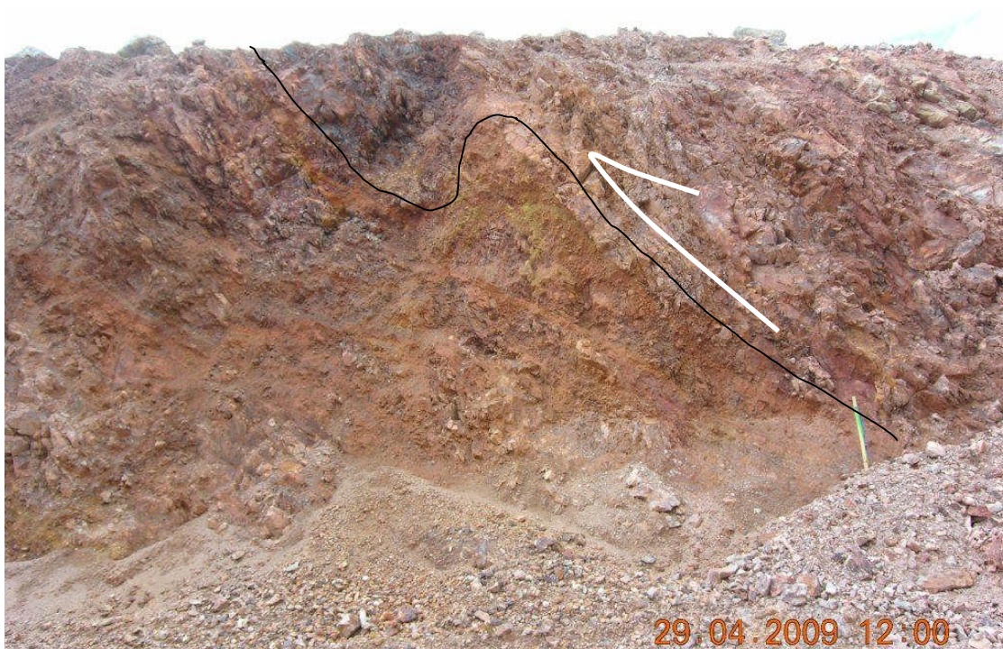
Foto N° 16: Tajo central nivel 3790. Estructura de arrastre. La ondulación engloba detritos (milonita) producto de la brecha tectónica previamente silicificada.
