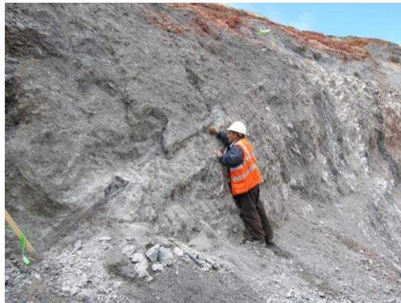
Foto N° 12: Nivel 3770 (tajo pared W) detalle de Falla Roxana, potencia 2m.
