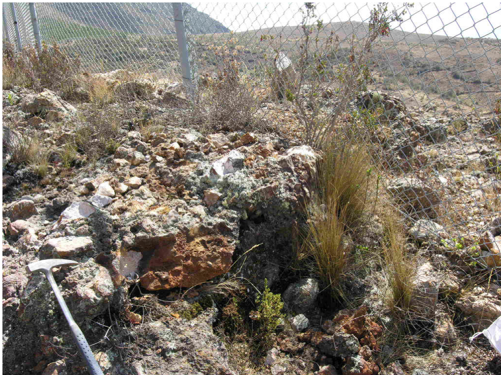
Foto N° 30: Depósito de pendiente. Un banco de conglomerado polimítico, clastos (QFP, Vuggy, piroclastos argilizados) subredondeados a angulosos, soportados en una matriz de detritos arcillas y óxidos terrosos.
