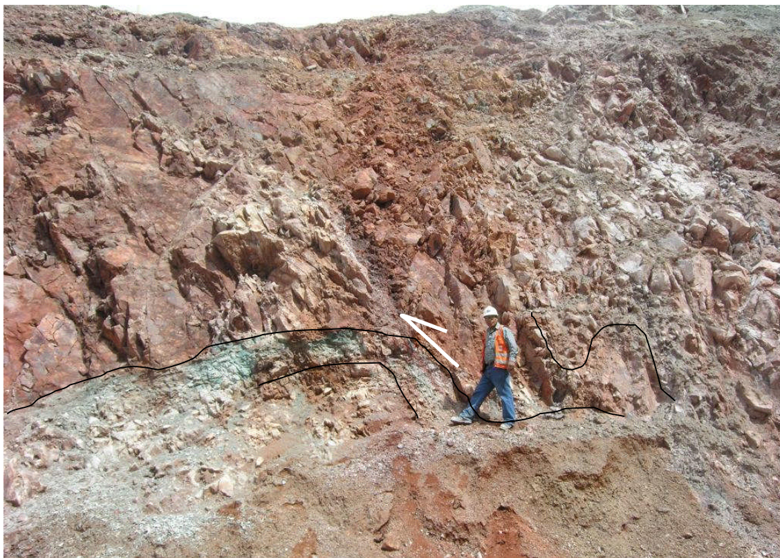
Foto N° 15: Tajo central nivel 3760. Estructuras de arrastre con ondulación tumbada hacia el NNE (indica dirección de empuje)
