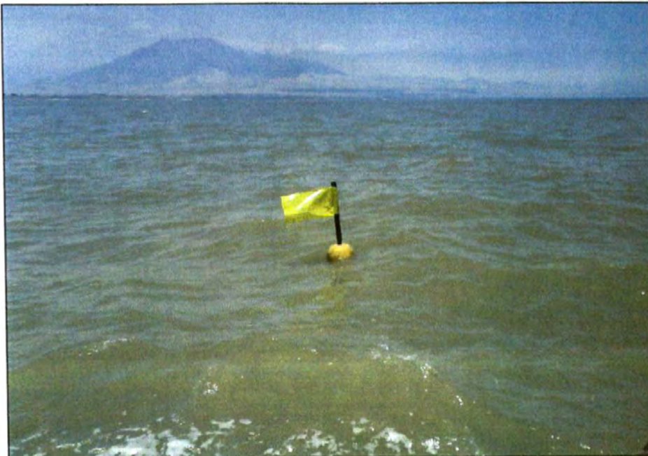
Fotografía 14.-Boya Amarilla, medición de corriente de marea
