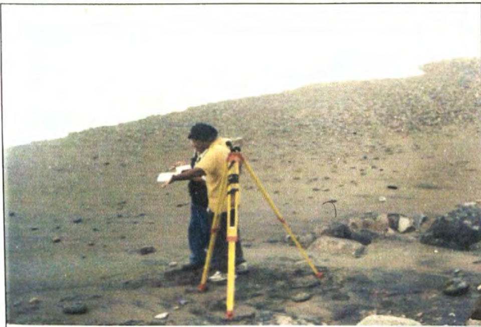
Fotografía 24-Taquimetría de la playa, usando el nivel
