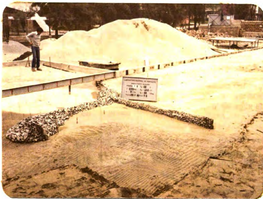
Fotografía 2.1.2 Sedimento usado en el modelo hidráulico del TP Salaverry
