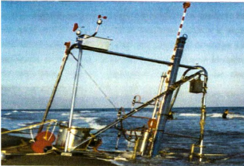
Figura 2.4.3.-Trineo con sensor de altura de olas, 6 correntómetro electromagnéticos, 2 sensores de sedimento en suspensión
