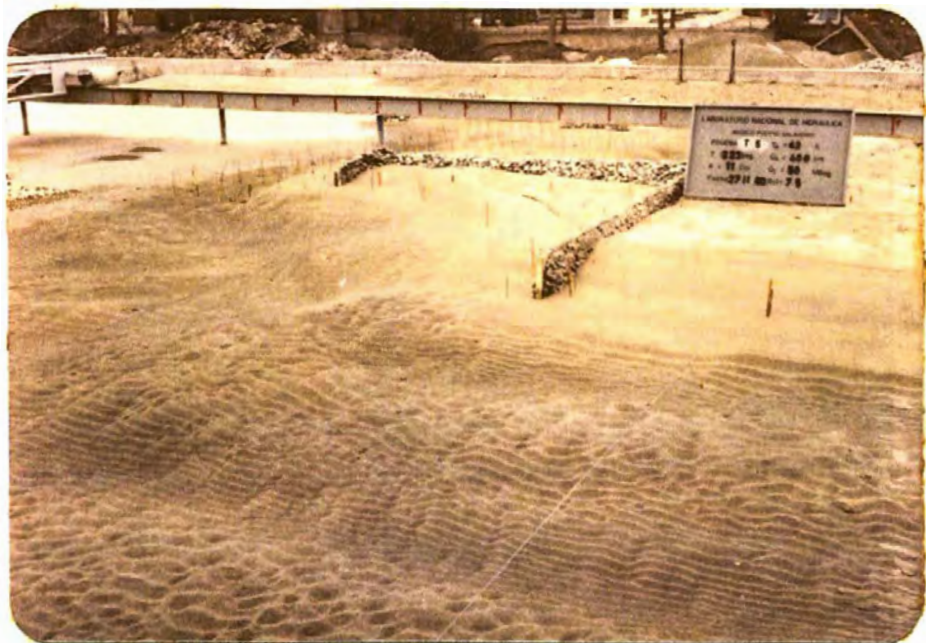
Fotografía 10.-Prueba T-5, formación del banco, t=43 horas
