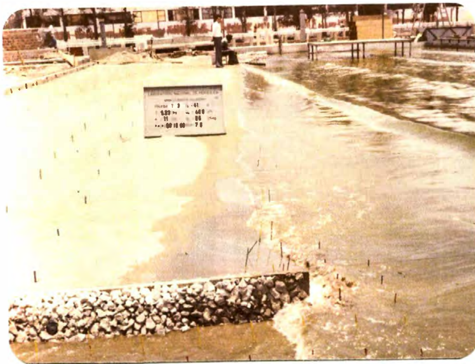
Fotografía 6.- Prueba T-3, vista general de la situación final, t=41 horas
