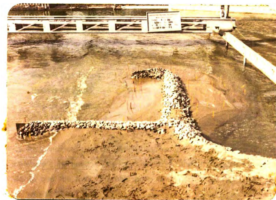
Fotografía 2.1.1 Investigación en modelo hidráulico del Puerto de Salaverry
