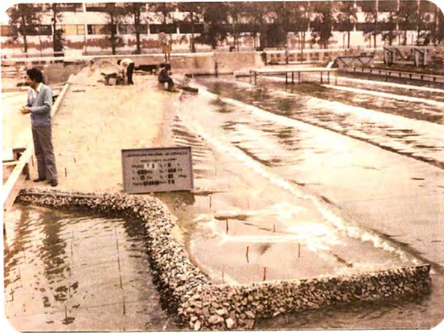
Fotografía 7.-Prueba T-2, vista general de la situación inicial, t_{ac}=0 horas
