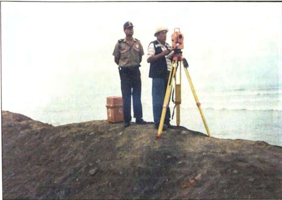
Fotografía 23-Ubicación de vértices de la Poligonal con la Estación Total
