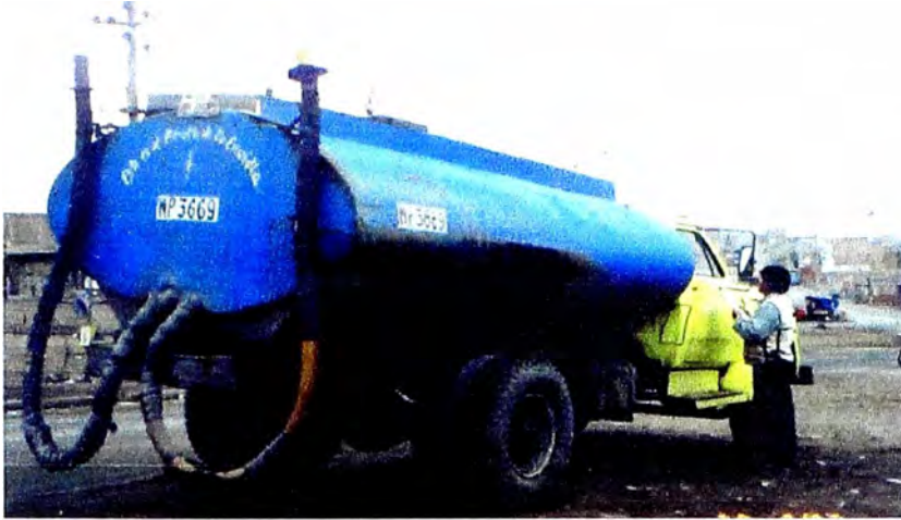
Camión cisterna, lleva agua para consumo desde el surtidor hasta las viviendas,
