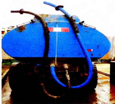
Mangueras con filtraciones y sin protección
