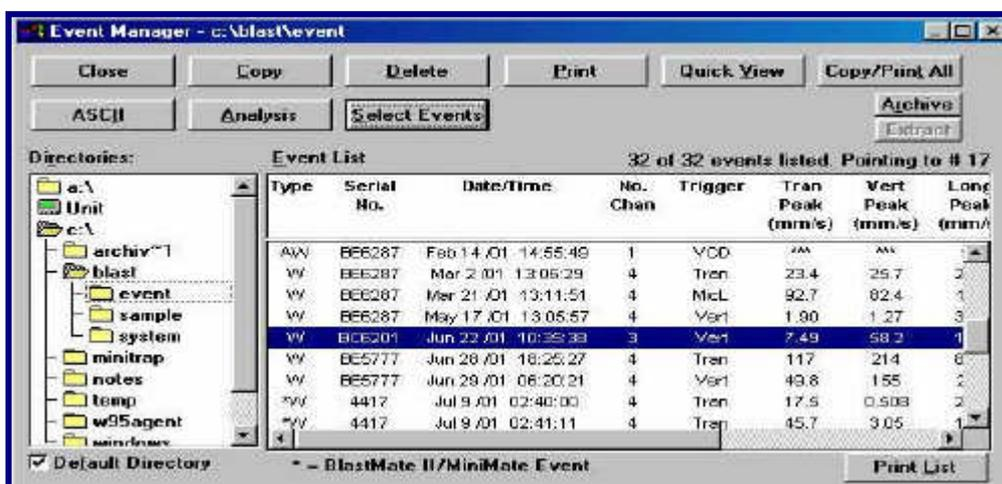
El sismógrafo debe estar apagado, el cual se enciende automáticamente apenas este la conexión correctamente hecha, luego mediante **Event Manager** empieza a dar lectura de los eventos que el equipo contenga.
