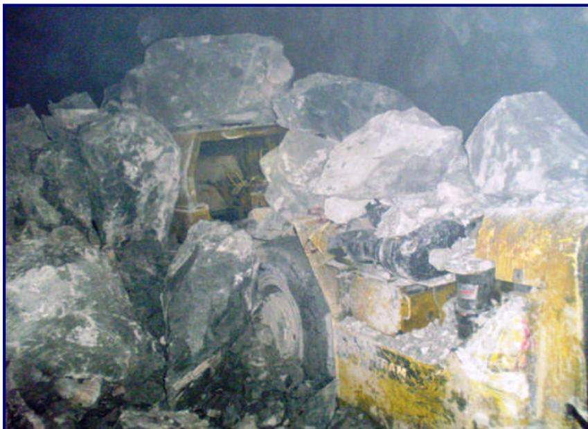
Debido a la excesiva carga explosiva detonando en simultáneo, se debilitaron las cajas del tajeo originando un accidente al equipo de limpieza con telemando.
