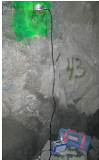
En la foto observamos la ubicación del geófono para lo cual se tomó en consideración la técnica de plancha empernada a la roca a través de un split set y cuyo objetivo principal es mantener fijo el geófono simulando el comportamiento vibracional del macizo rocoso.
