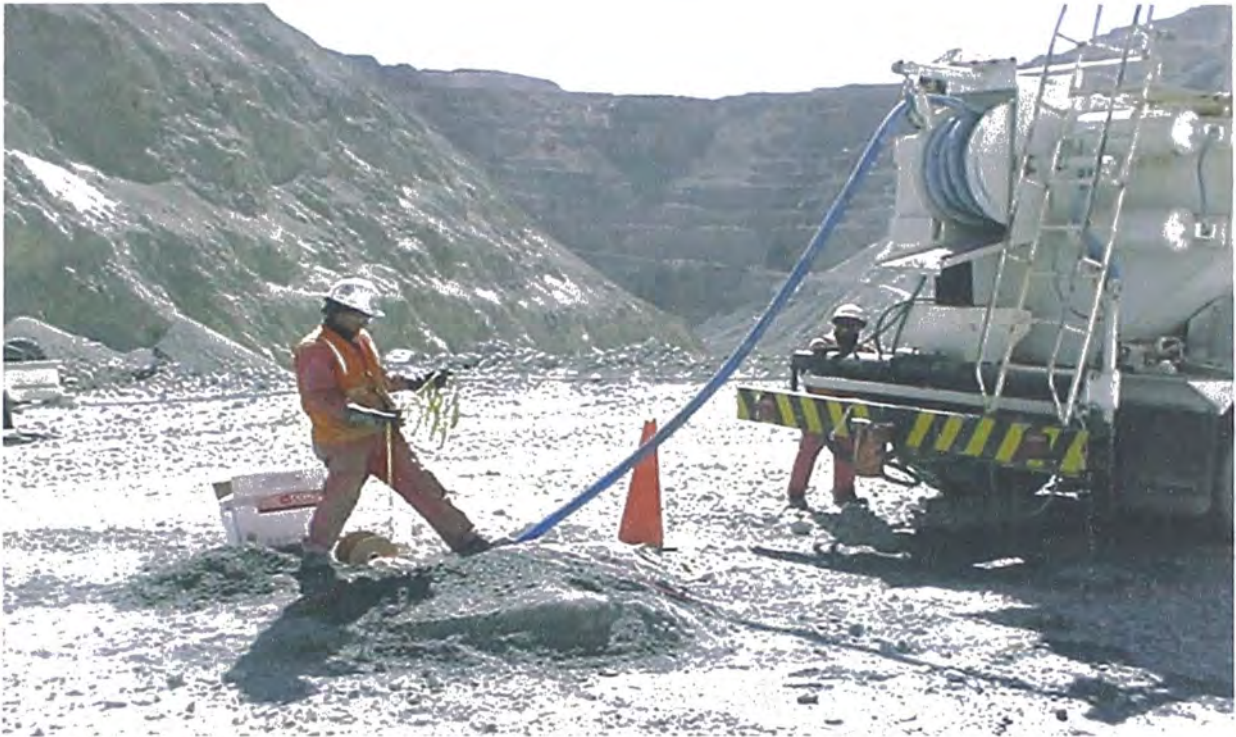
Carguío de explosivos
