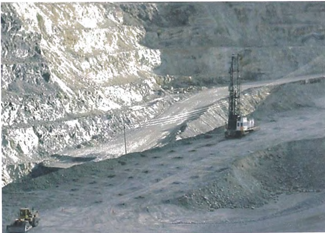
Perforadora DrillTech 4005, perforando taladros de producción con malla de 7.5x7.5 m
