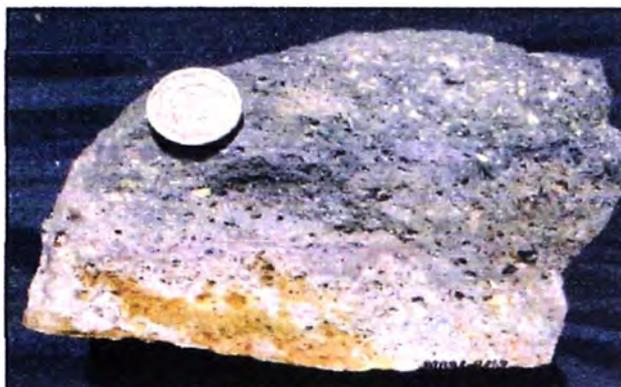
**Andesita porfírica alterada a sílice residual, cristales con azufre (s), pirita (py) fina disseminada en la sílice gris oscura, lado derecho covelita (cov), pátina de óxidos en la parte inferior (ox).**
