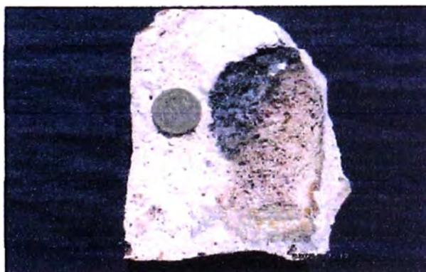
**Piroclasto alterado a sílice residual, hematita botroidal (hem).**
