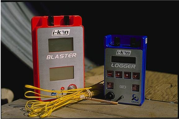
El detonador puede ser programado en un rango de entre 0 - 15000 ms
