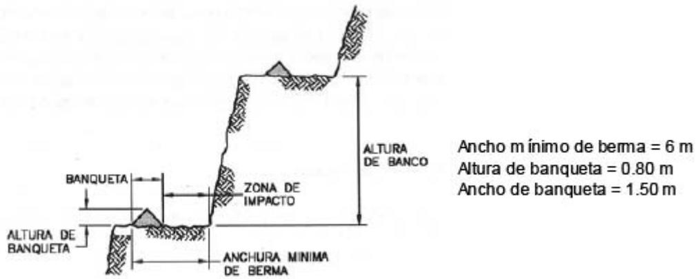
Ilustración 4.13: Consideraciones geométricas para el diseño de los bancos
