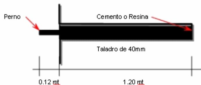
c.- Instalar una plataforma de metal (10cm x10cm x 10cm) en el sobresaliente del perno bien pegada a la roca y ajustada con un perno par luego colocar el geófono con
