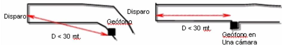
b.- En el lugar donde va el geófono, Perforar un taladro de 1.2m de profundidad seguidamente instalar un perno con cemento o resina con la finalidad de que el perno quede bien fijado y no presente oscilaciones que pueden alterar la toma de datos de vibración:
