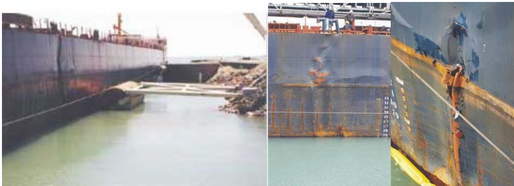
Figura 1.3: Pandeo del costado de un navío
