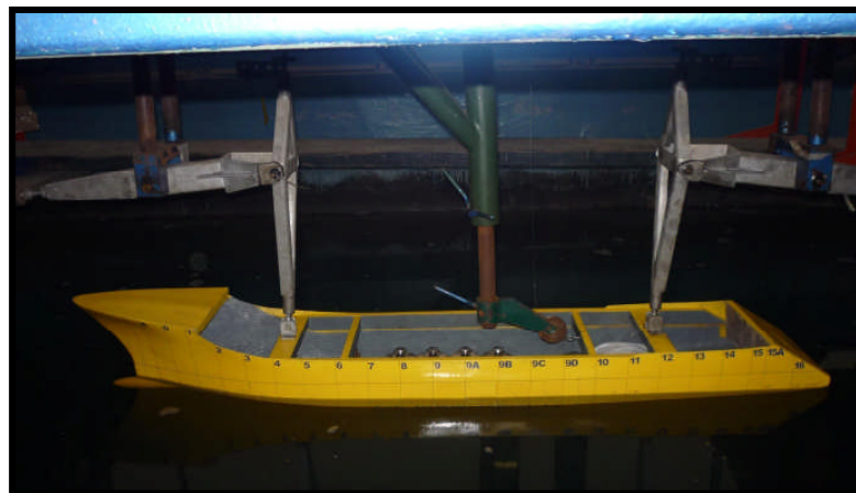
Figura 5-12: Modelo del Casco en el Tanque de Pruebas
