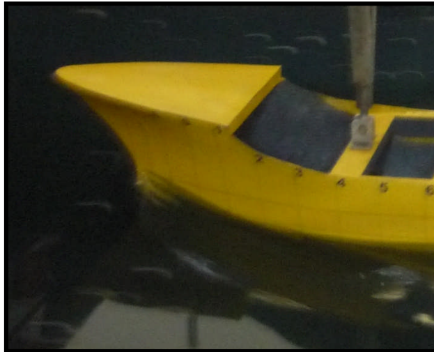
Figura 5-17: Salida de Puerto Sin bulbo – 10.83 nudos
