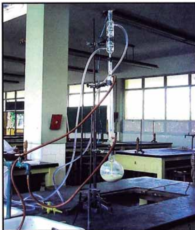
Figura 5.33: Diseño a reflujo del proceso de lixiviación.
