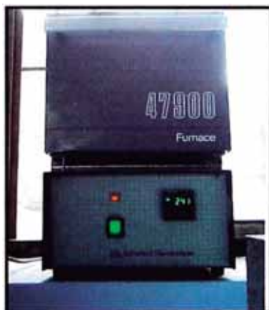
Figura 5.12: Mufla utilizada en la pre-calcinación de la arcilla.
