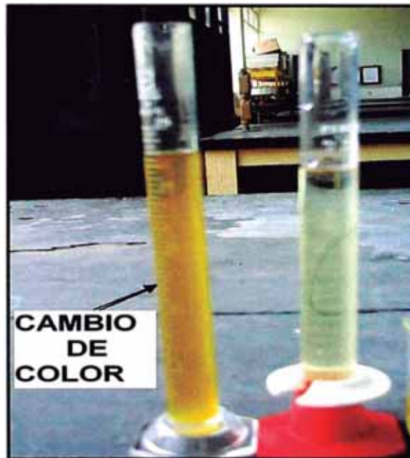
Figura 5.11: Muestra contaminada con óxido de hierro.
