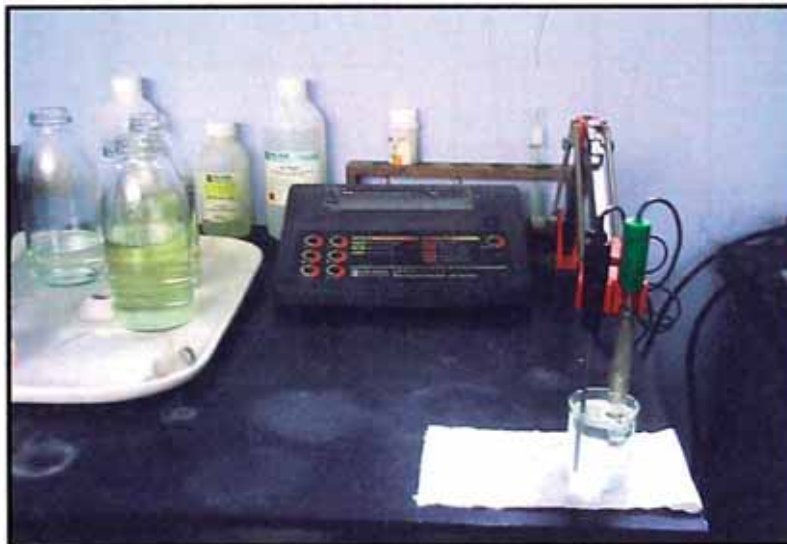
Figura 5.9: Medición del pH de la solución lixiviada.
