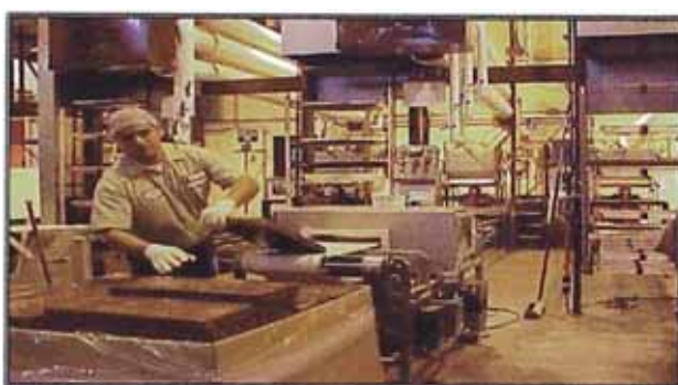
Fig.Nº13: Paso por detector de metales
