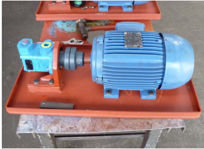
Figura 6.22 Bomba hidráulica principal, conectado a un motor eléctrico.
