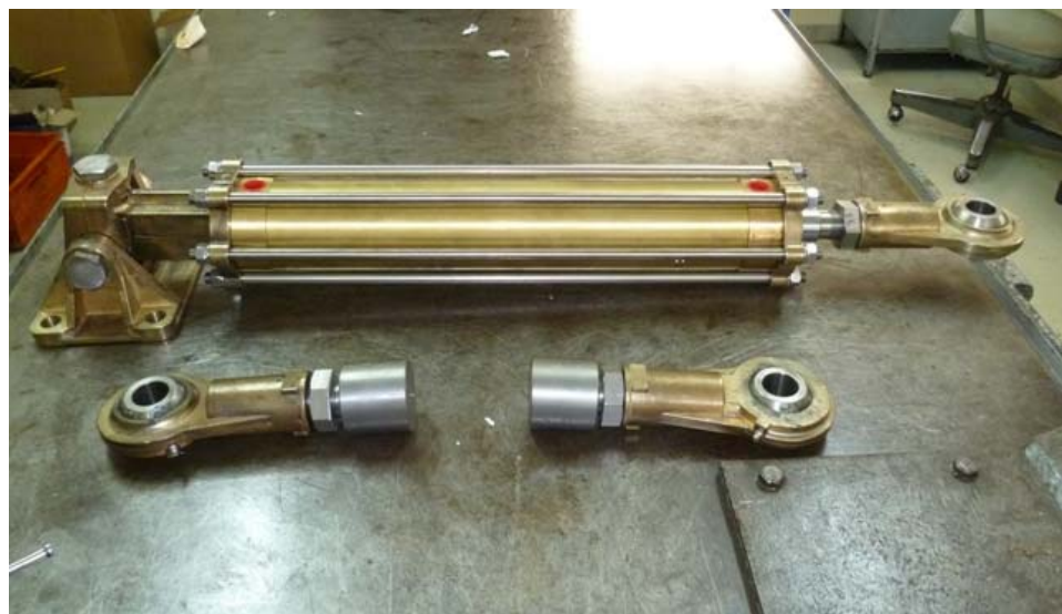
Figura 6.13 Muestra del pistón hidráulico empleado en el servomotor.
