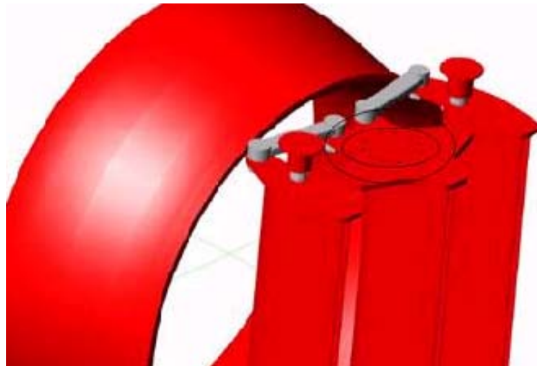
Figura 6.5 Zona de transmisión del torque en las palas (marcada con círculo negro).
