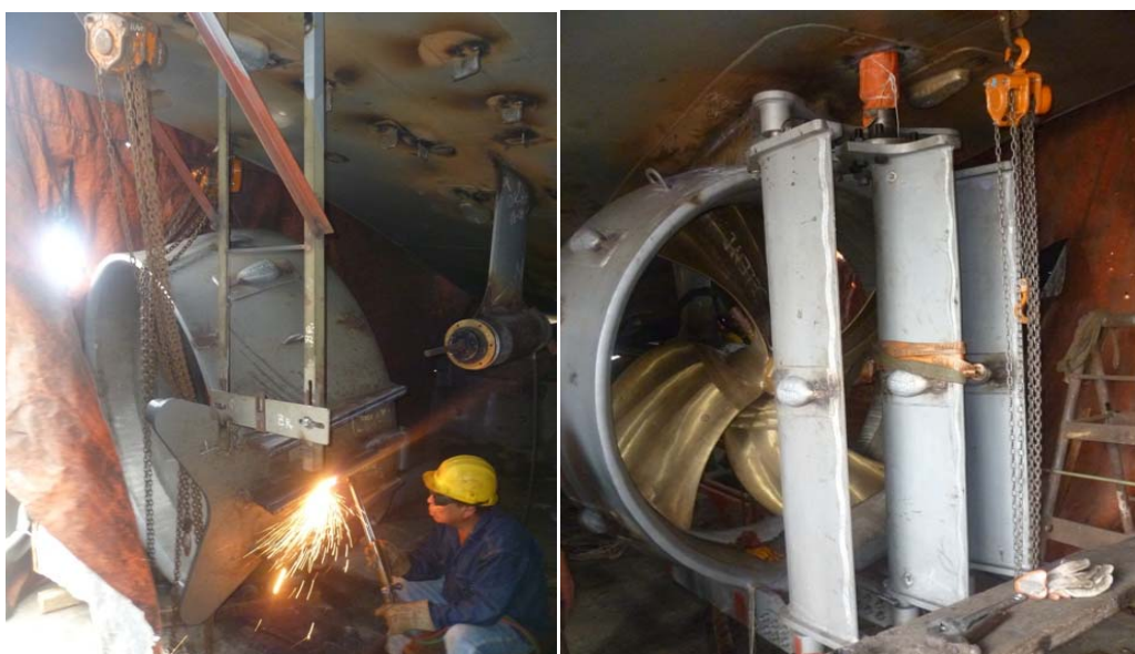
Figura 6.30 Instalación del grupo de tres palas con tobera en la zona de popa.
