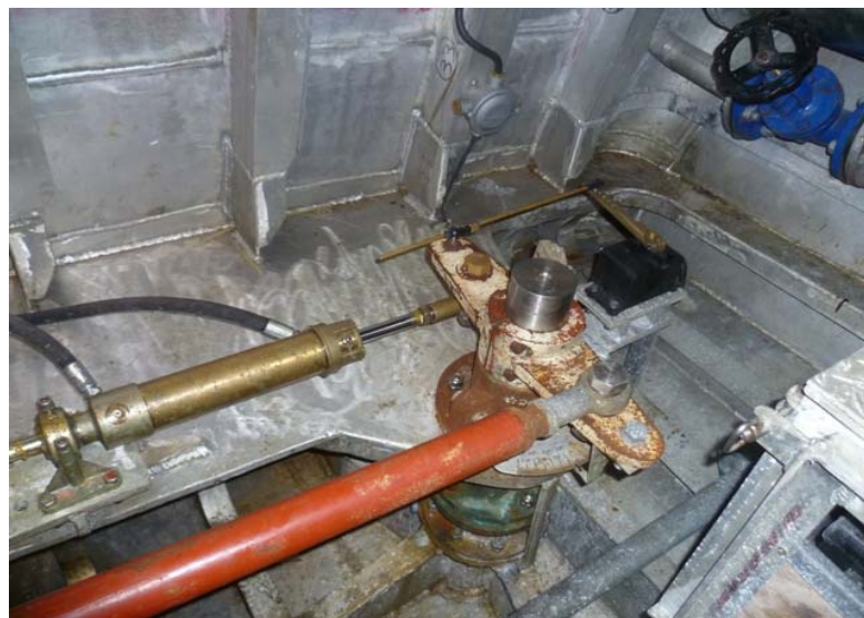
Figura 3.9 Imagen del sistema hidráulico de gobierno del yate mencionado.
