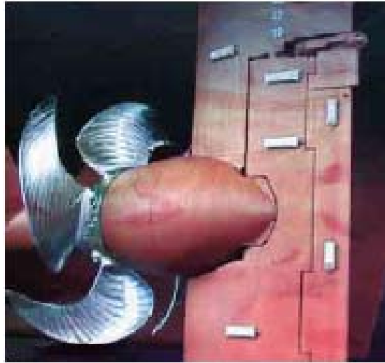
Figura 4.12 Timón de alto rendimiento con placas anti-corrosión.
