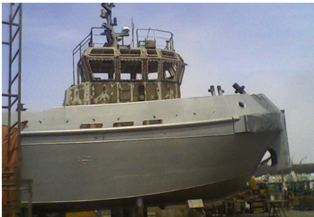
Figura 6.1 Imagen del remolcador en construcción en el astillero.
