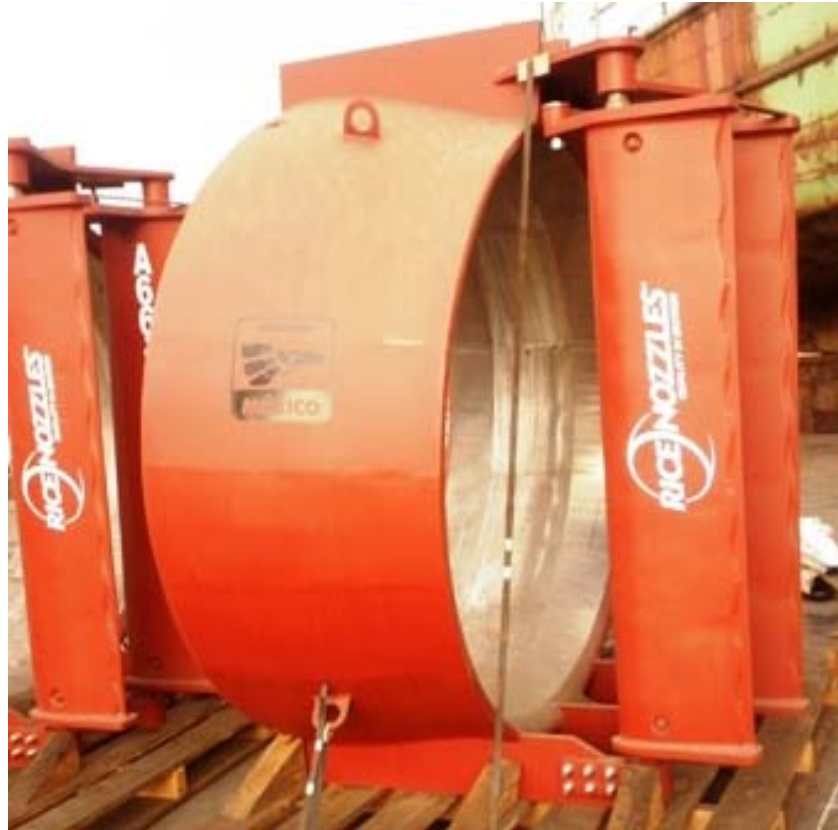
Figura 6.3 Grupo de tres palas de gobierno con tobera de hélice propulsiva.
