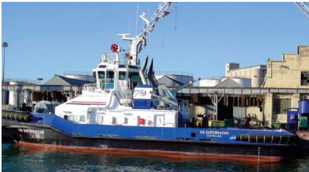
Figura 2.7 Remolcador de salvamento que posee una grúa hidráulica.
