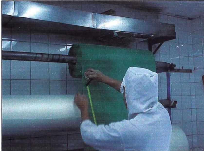
Figura 4. Medición y corte del poliuretano
