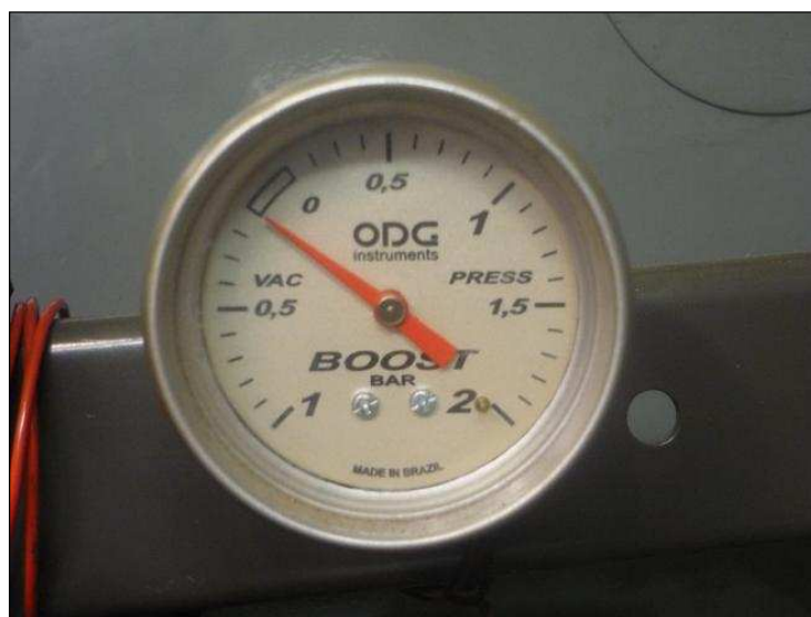
FIG. 5.5. Manómetro utilizado en la Medición de la Presión en la Admisión.
