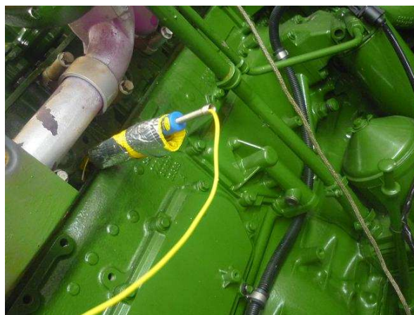
FIG. 5.3. Termopar tipo K instalado en la culata del motor.
