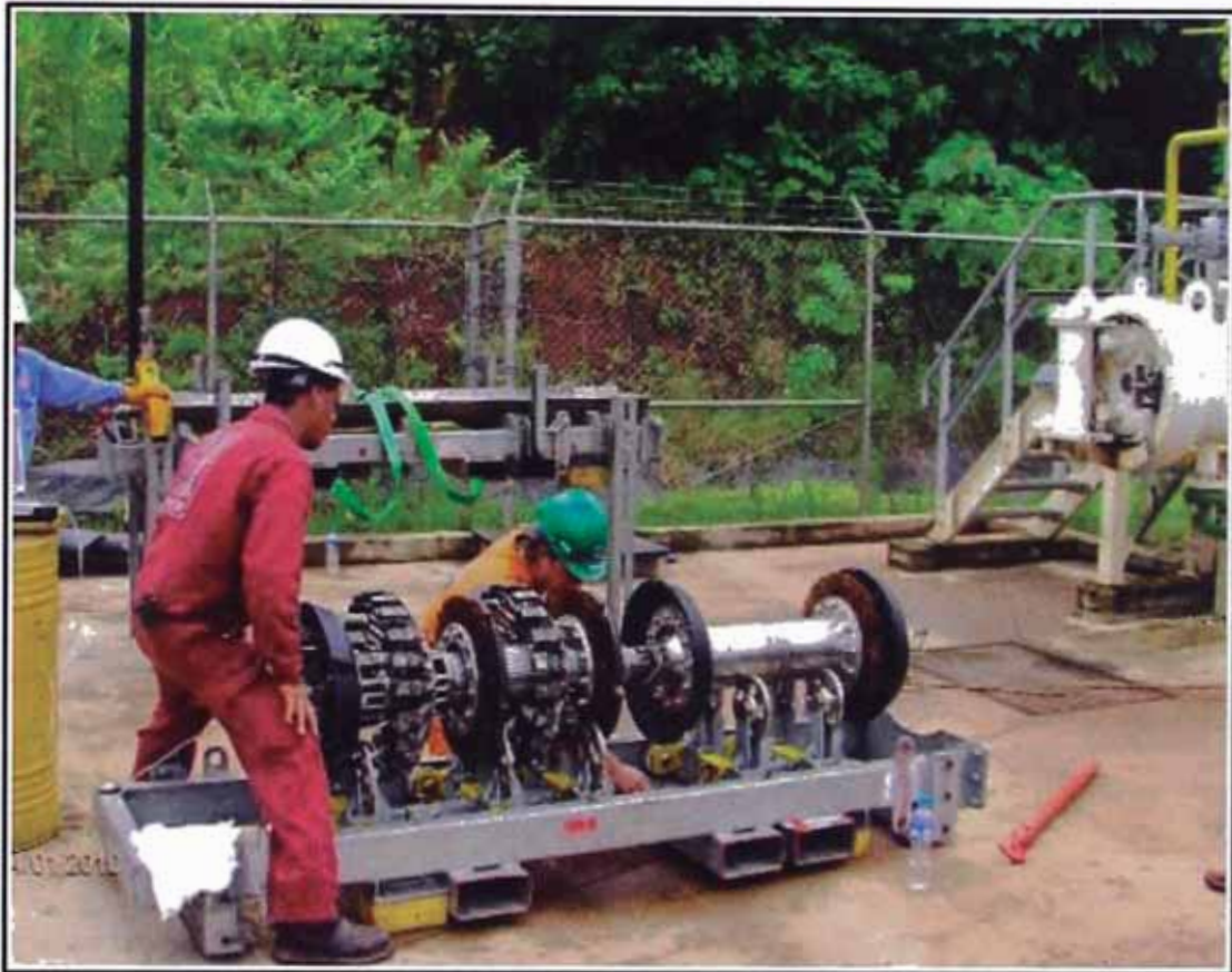
Gráfico N°37: Pig Inteligente para gaseoducto de 20" \phi .
