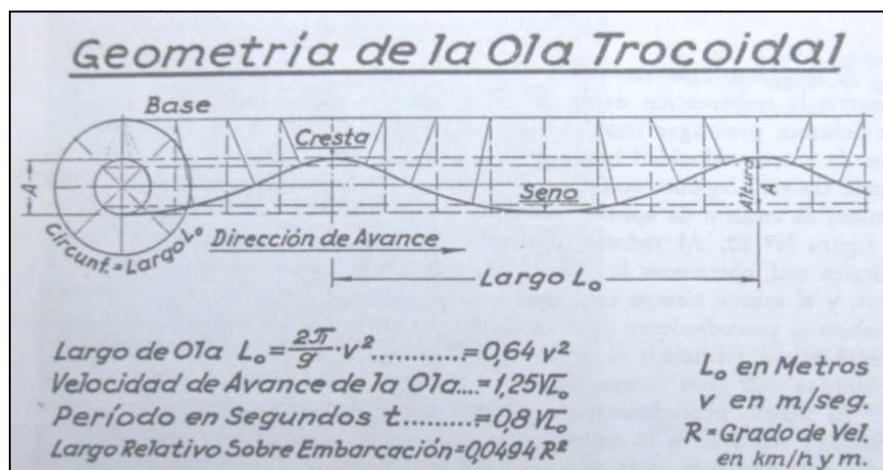
Fig. 4.5 Geometría de la ola trocoidal. (Ref. Cruceros y Lanchas Veloces, Juan Baader, Pág. 30)
