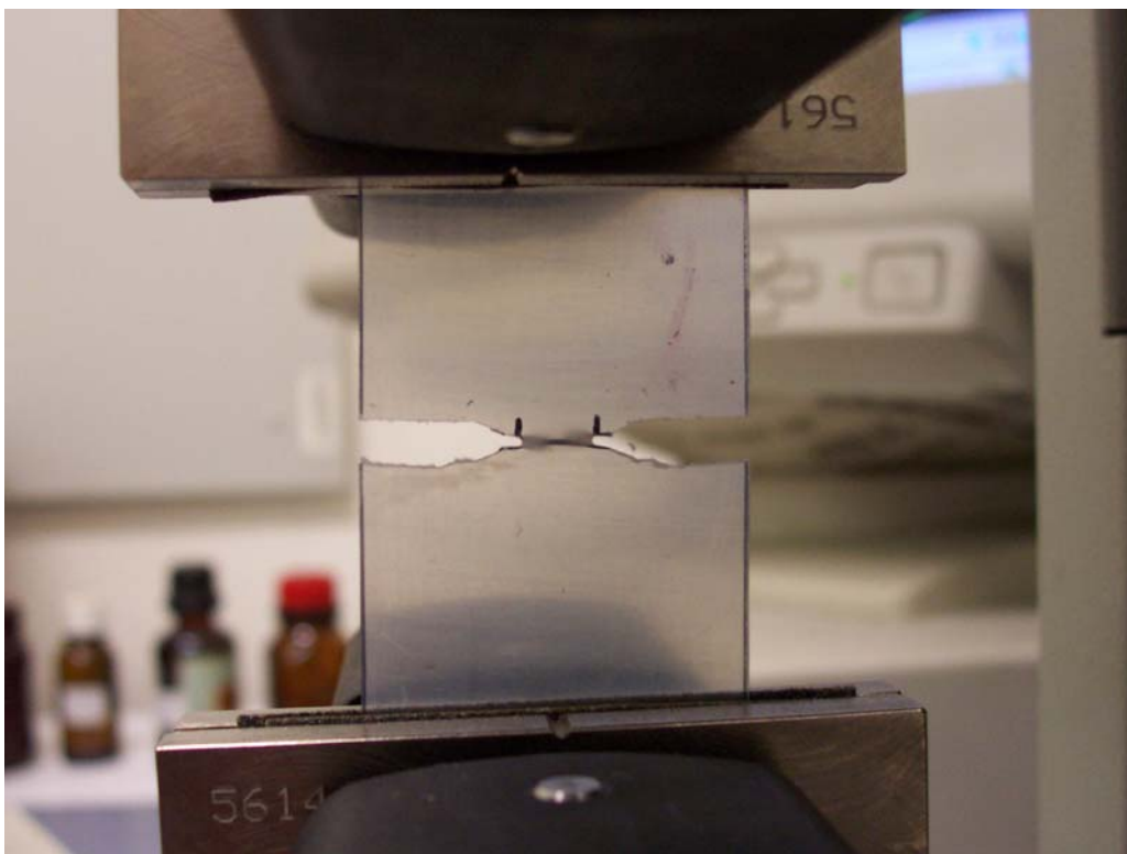
Fig. 4.7 Carga aplicada: 76.49 N, Deformación: 0.90 mm (2)
