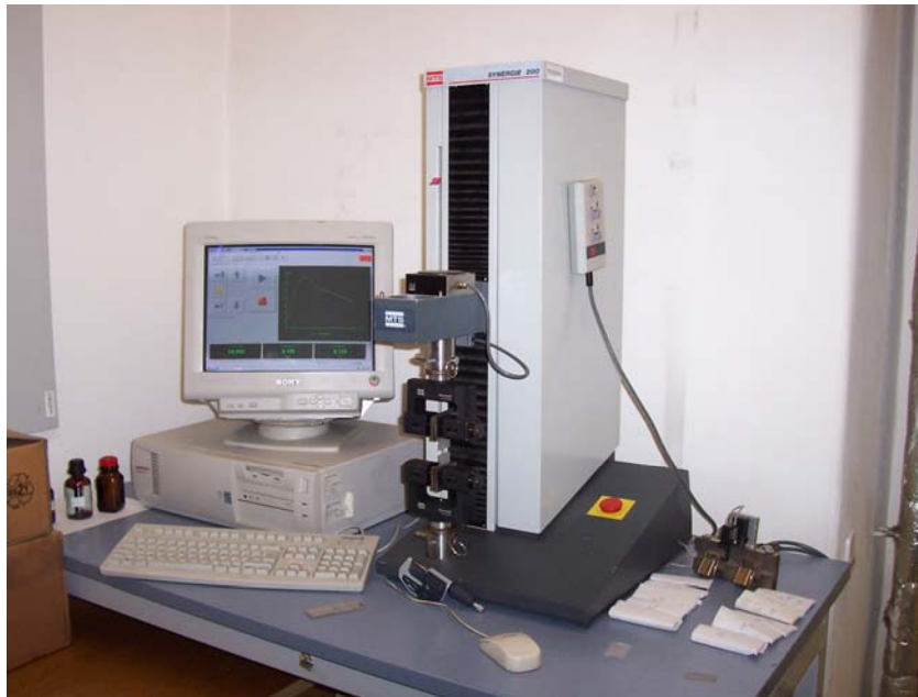
Fig. 4.4 Máquina de tracción MTS Synergie 200, Universidad Tecnológica de Viena
