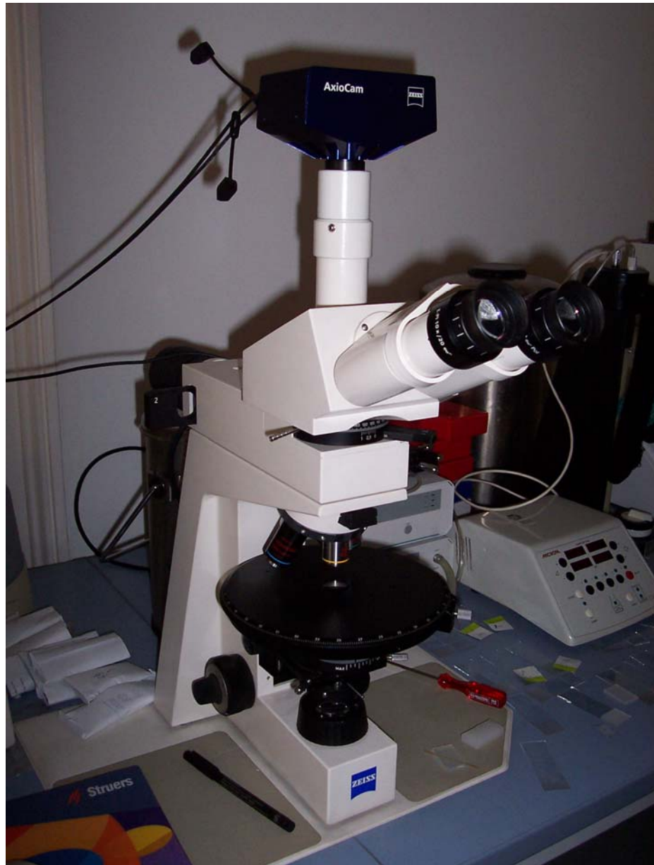
Fig. 4.18 Microscopio Axiolab Pol, Universidad Tecnológica de Viena
