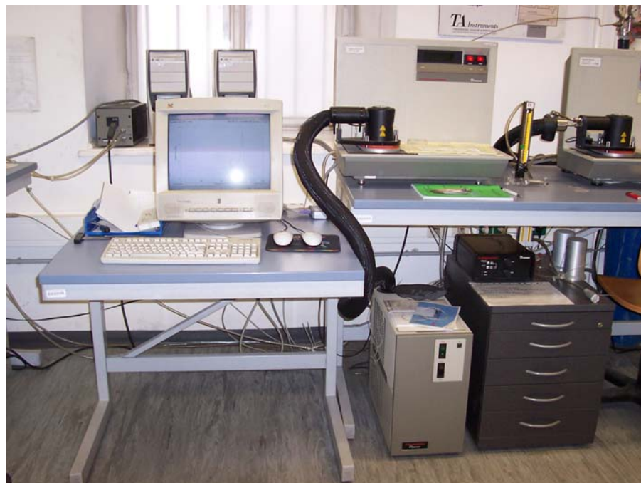
Fig. 4.14 Máquina DSC usada en este proyecto, Universidad Tecnológica de Viena
